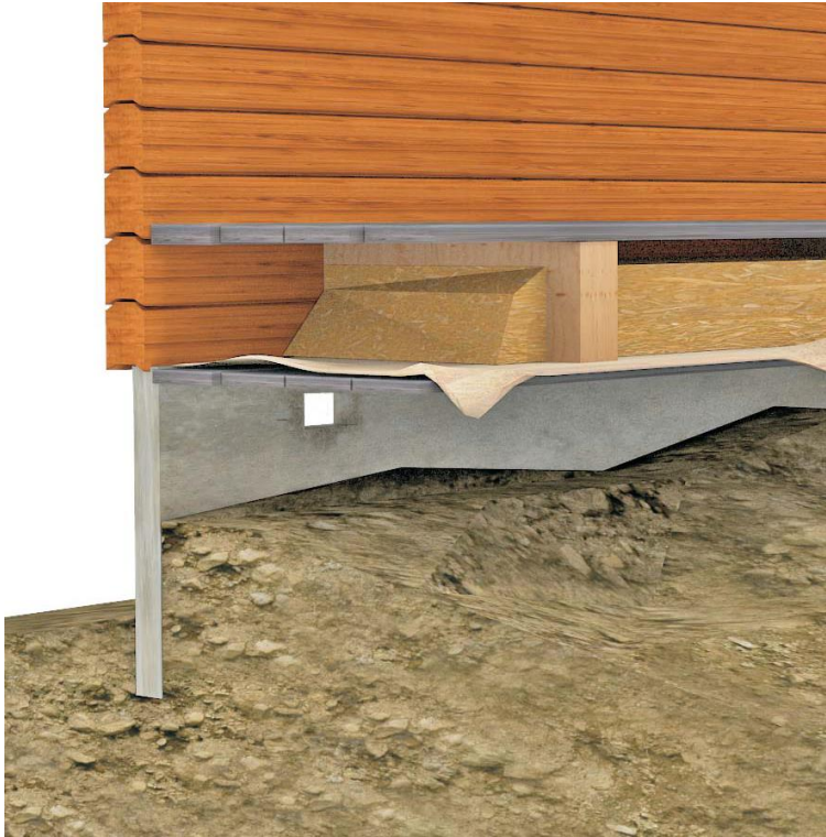
Kuva 11. Heikosti tuulettuva rossipohjarakenne on riskialtis rakenneratkaisu [11, s.85]
