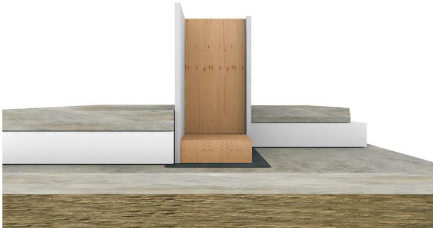
Kuva 9. Lattiapinnan alapuolelle ulottuvaan väliseinärakenne [11, s.10]
