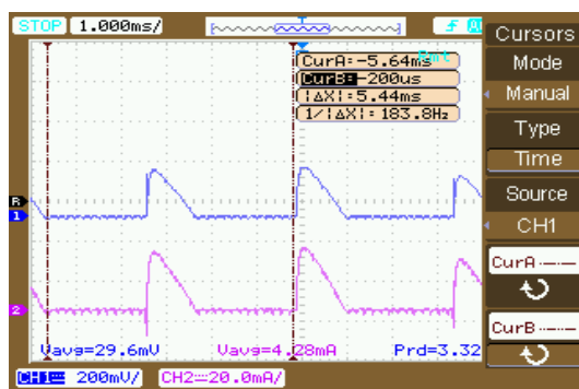
KUVIO 9. Oskilloskoopin kuva, \alpha \approx 105^\circ , kuorma R
