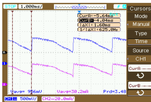
KUVIO 3. Oskilloskoopin kuva, \alpha \approx 35^\circ , kuorma R
