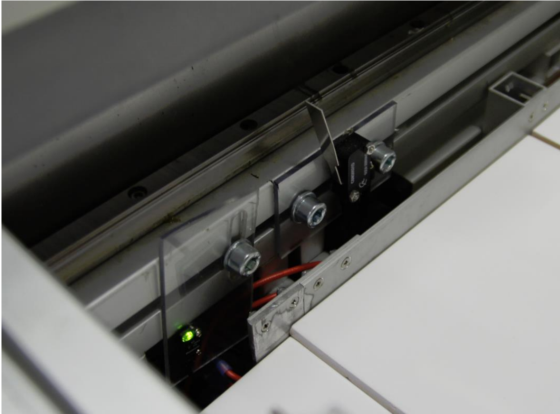
KUVA 17. Valokennoanturin ja vetimen eturajan kiinnitys prototyypin profiilikiskoon (kuva: Mika Mylly)
