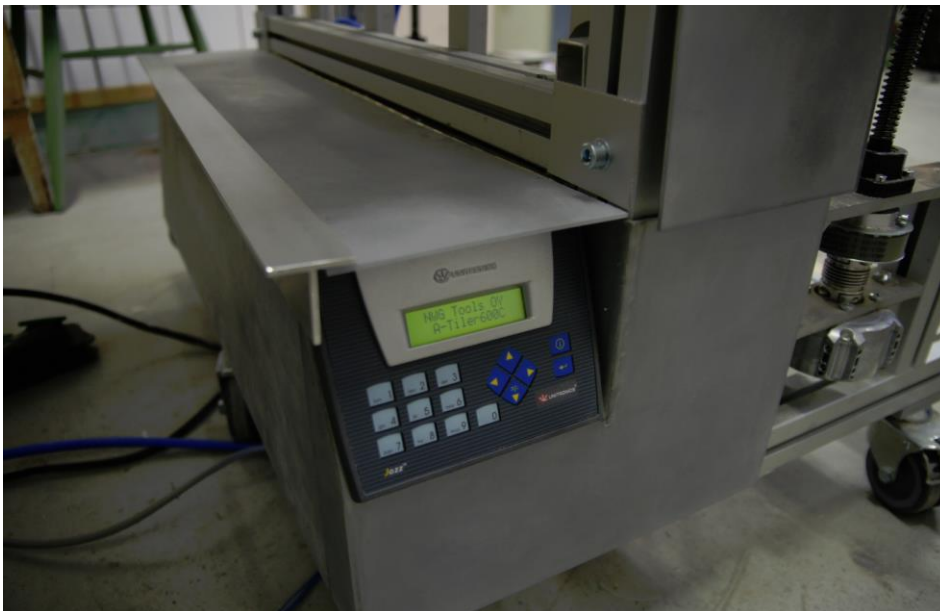
KUVA 16. Unitronics Jazz -logiikka laitteessa asennettuna (kuva: Mika Mylly)
