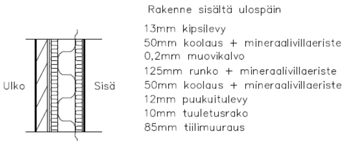
Kuva 4. Uusi ulkoseinärakenne (Ulkoseinä 1).
