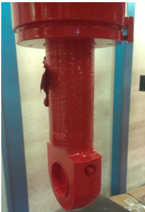
KUVA 9. Sylinterin varren suojaus teippaamalla (Valokuva Turunen 2014.)
