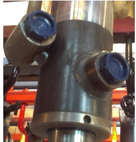
KUVA 8. Sisäkierteen suojaus tulpalla (Valokuva Turunen 2014.)
