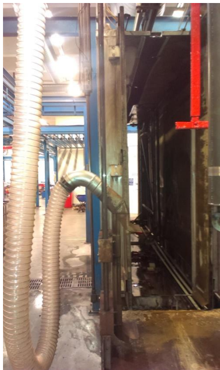
KUVA 3. Rautafosfatointipesukoneen ulostulo ja kuivatuspuhallin (Valokuva Turunen 2013.)
