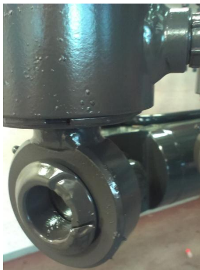
KUVA 13. Roskia maalipinnassa (Valokuva Turunen 2014.)
