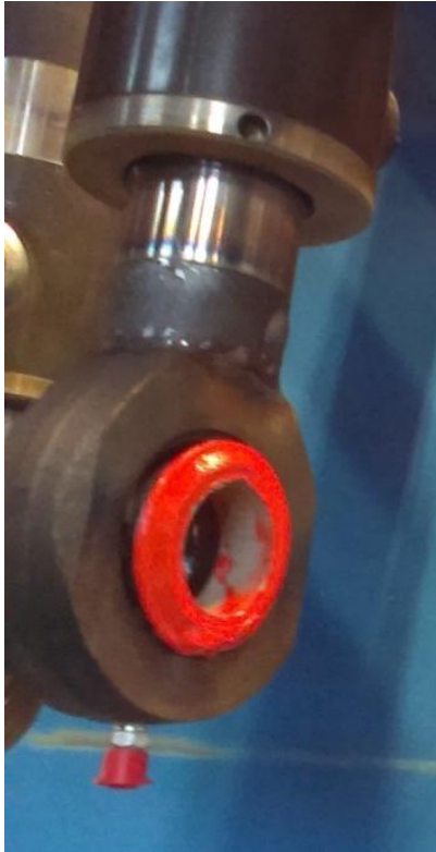
KUVA 7. Laakeroinnin ja päässä olevan kierteen suojaus (Valokuva Turunen 2014.)
