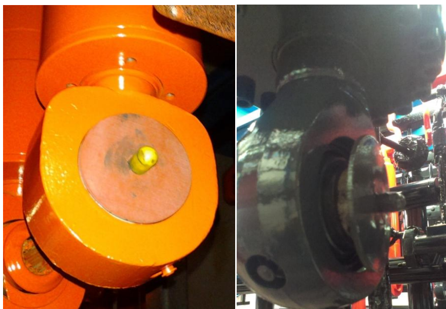
KUVAT 5 ja 6. Laakeroinnin suojaus uudelleen käytettävällä tulpalla (Valokuva Turunen 2014.)
