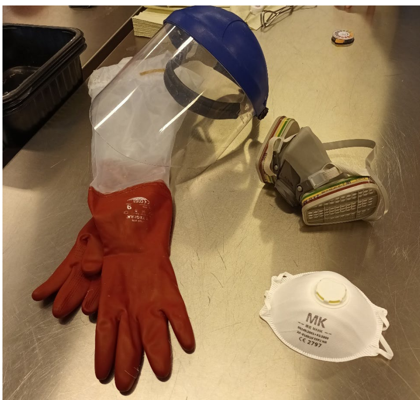
Kuva 7. Roiskesuojana kasvoille ja käsivarsille toimivat pitkävartiset suojahanskat ja visiiri. Puolinaamari hengityssuojaimet suojaavat epäpuhtaalta hengitysilmalta.
