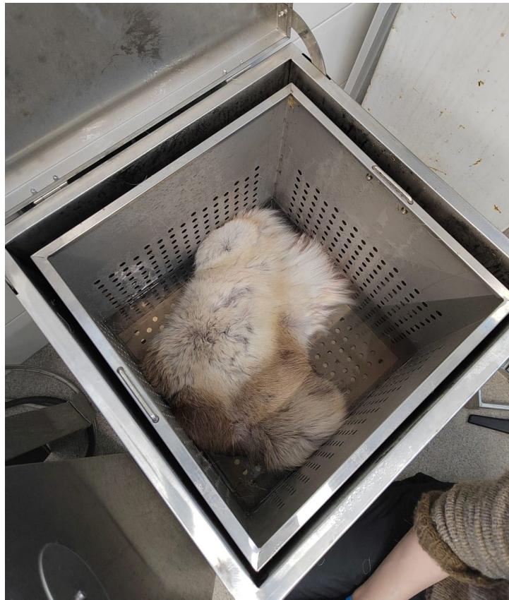
Kuva 14. Testikäytössä 120 litran kalttausallas. Teollisesti valmistettuja kalttausaltaita on saatava maailmalta myös isompikokoisena, joilla onnistuu kokonaisen taljan kalttaminen. (Kuva: Niina Mattila).
