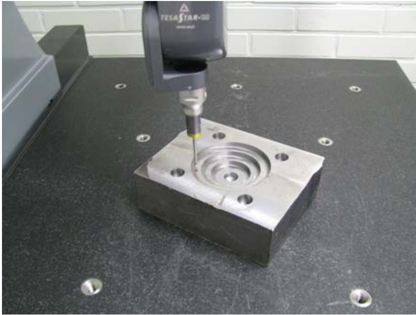
Kuva 35. Geometrisen oikaisun avulla näinkin vinoon mittauspöydälle sijoitettu kappale voidaan mitata oikein.
