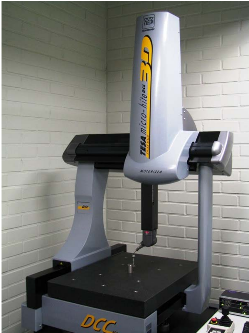
Kuva 13. Tesa Micro Hite 3D DCC -koordinaattimittauskone
