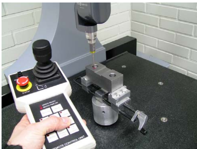
Kuva 16. Mitattavan kappaleen sijainnin määrittävien piirteiden osoittaminen.
