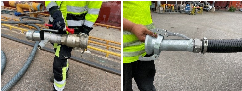
Kuva 8. Erilaisia liittimiä mustien ja harmaiden vesien tyhjennyksessä. Liittimet ovat esimerkiksi lokaliitin käytössä olevia, kuten Valducci, Perrot, Bauer, Tykoflex (Kuva: Anniina Hiltunen).
