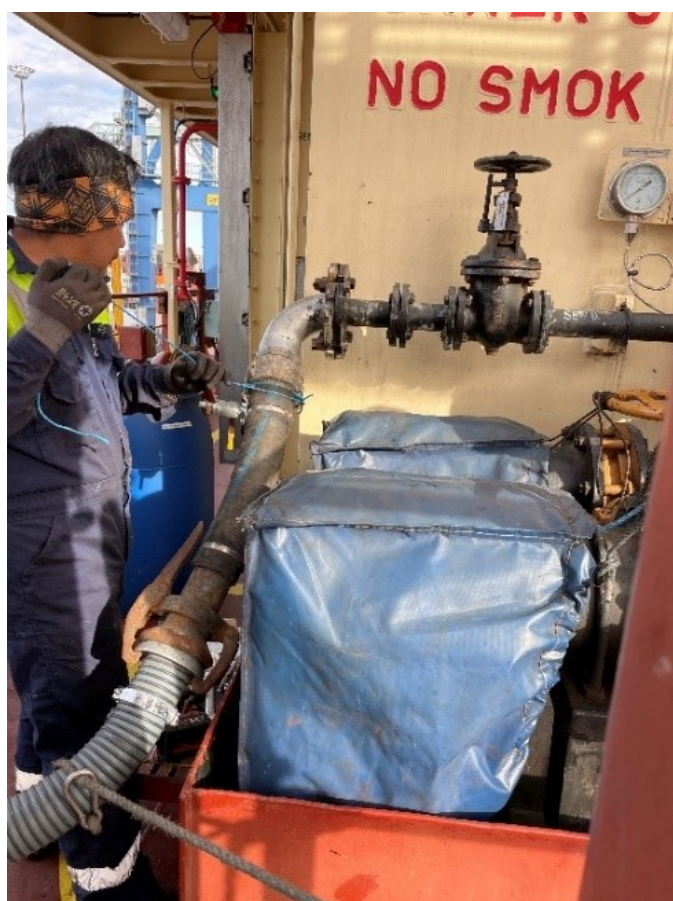
Kuva 9. Tyhjennysletkun kiinnitys liittimellä laivassa. (Kuva: Anniina Hiltunen).
