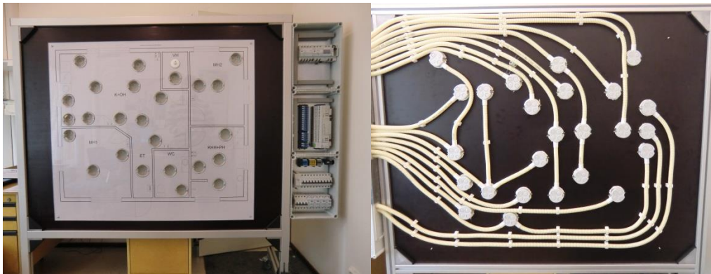
KUVA 12. Profiilirunko ilman väylälaitteita ja valoja
