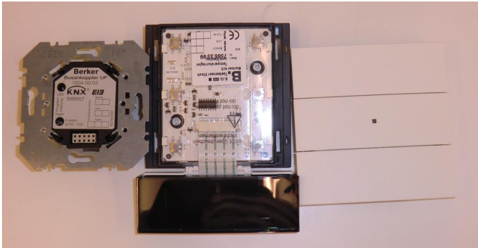
KUVA 14. Vasemmalta väyläliityntäpohja, painikemoduuli näytöllä ja painikkeet
