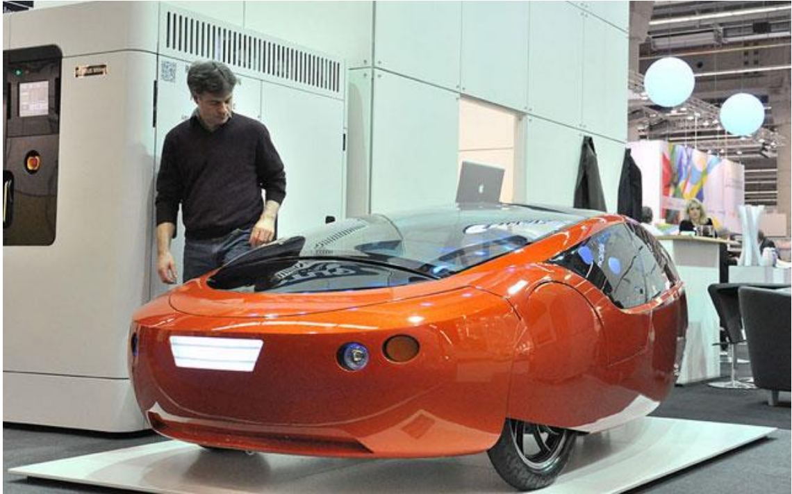
Kuva 8. KOR EcoLogic -yhtiön Urbee 2 -auton runko on tulostettu kokonaan FDM-tekniikalla [16].
