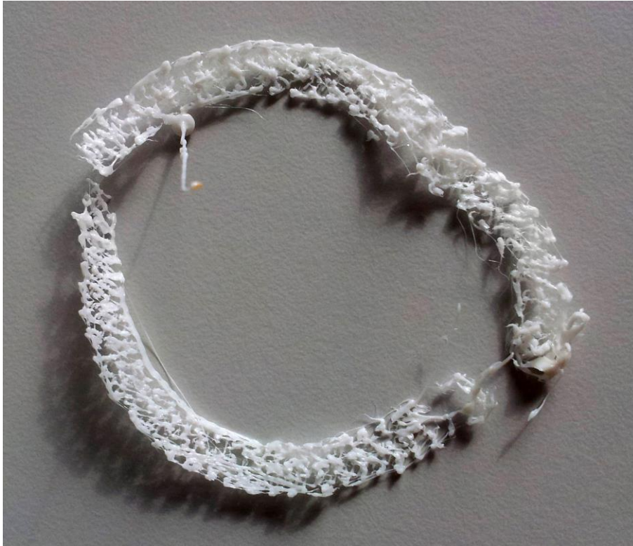
Kuva 22. Tulostusjälki harsottuu ja hajoaa, jos kuumapää on liian lähellä alustaa.
