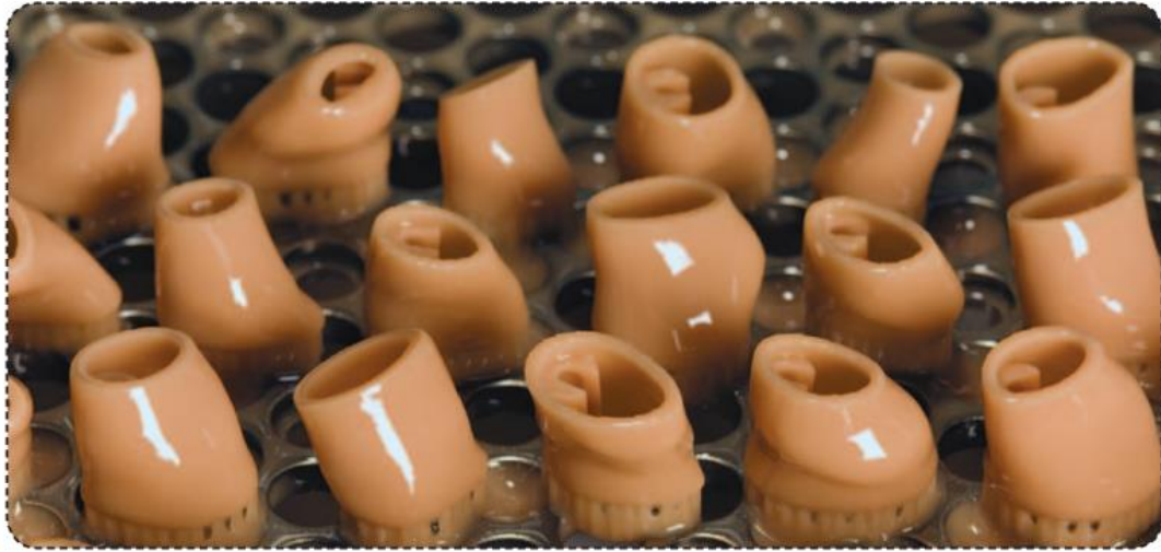
Kuva 9. Widex-yhtiön valmistamia kuulolaitteita. Kuulolaitteet valmistetaan yksilöllisesti asiakkaan korvakäytävään sopiviksi [18].
