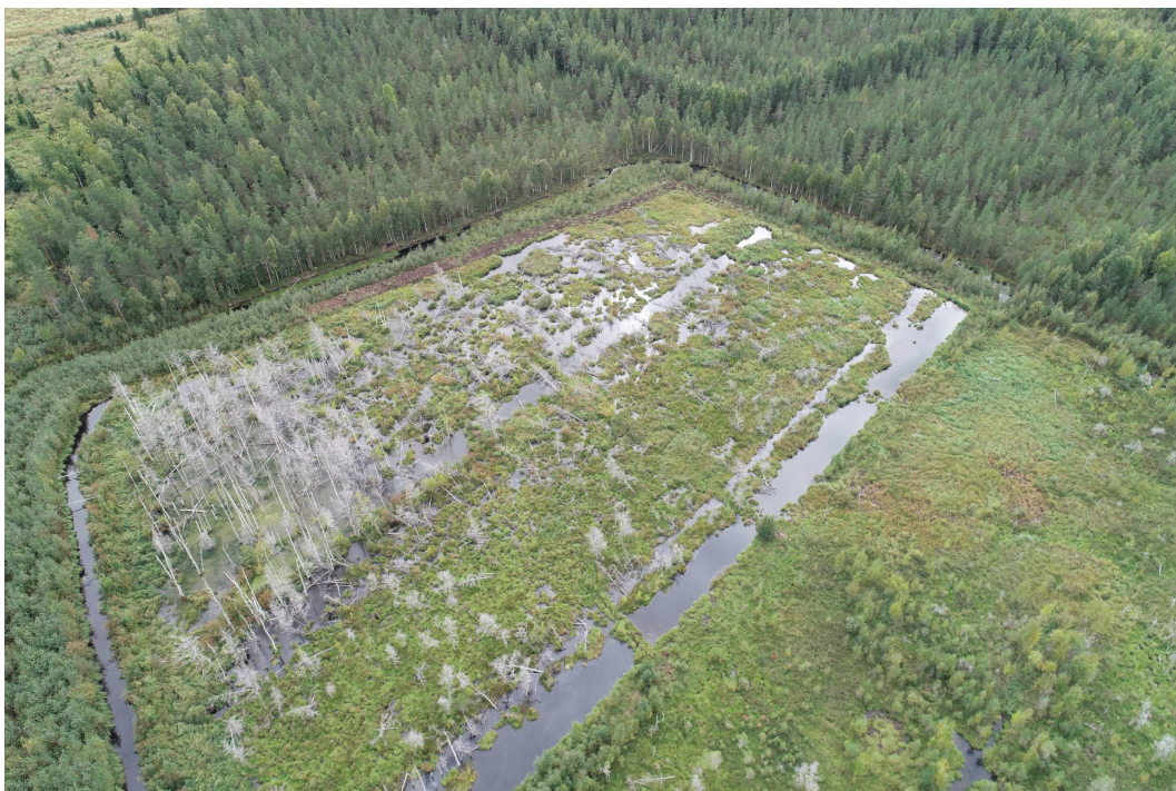
Kuva 11. Entiselle turvetuotantoalueelle rakennettu vesiensuojelullinen pintavalutus-kenttä. 43
