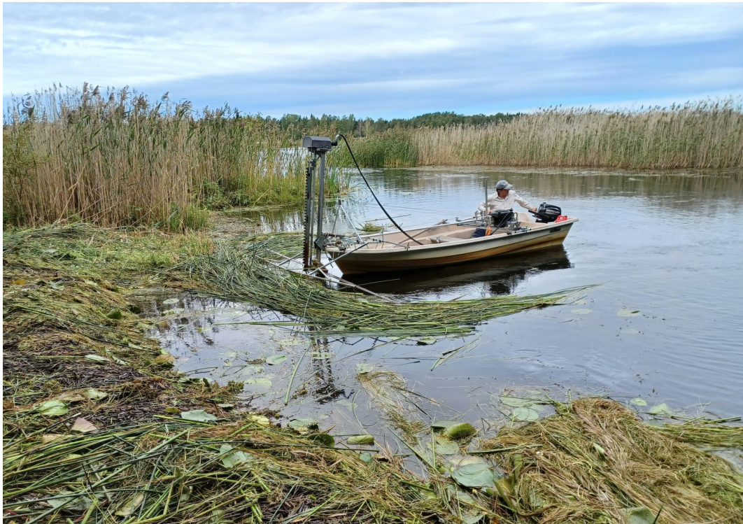
Kuva 7. Vesikasvillisuuden koneellinen niitto moottoriveneeseen kytketyllä niittokoneella Karperönjärvellä vuonna 2022. 29
