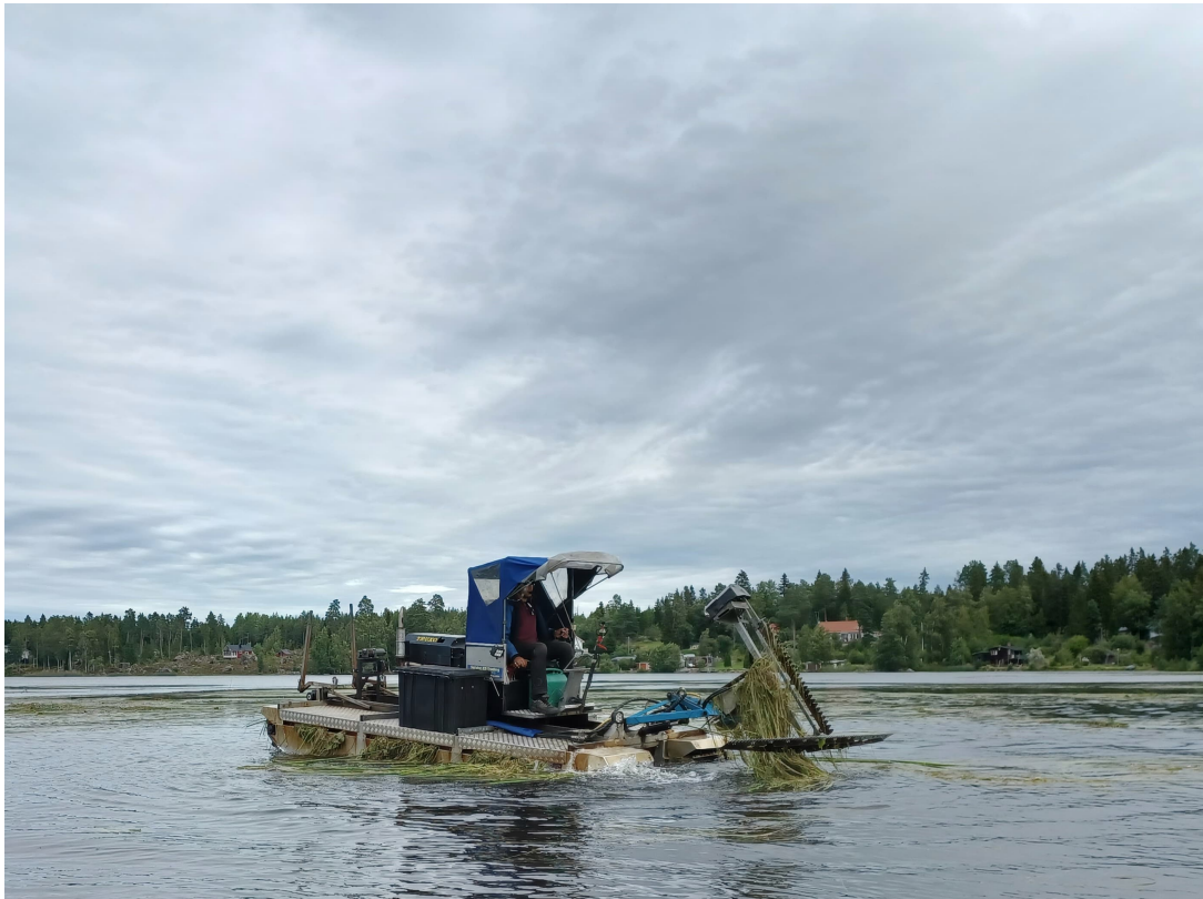
Kuva 6. Vesikasvillisuuden koneellinen niitto Karperönjärvellä vuonna 2022. 28
