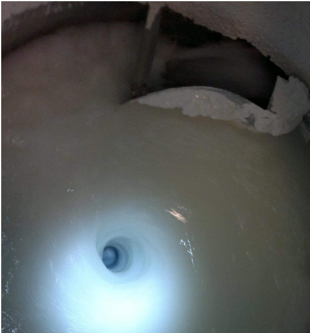
KUVA 10. Pastasäiliössä imupyörre (Metsä Board Tako, Simo Wilen)
