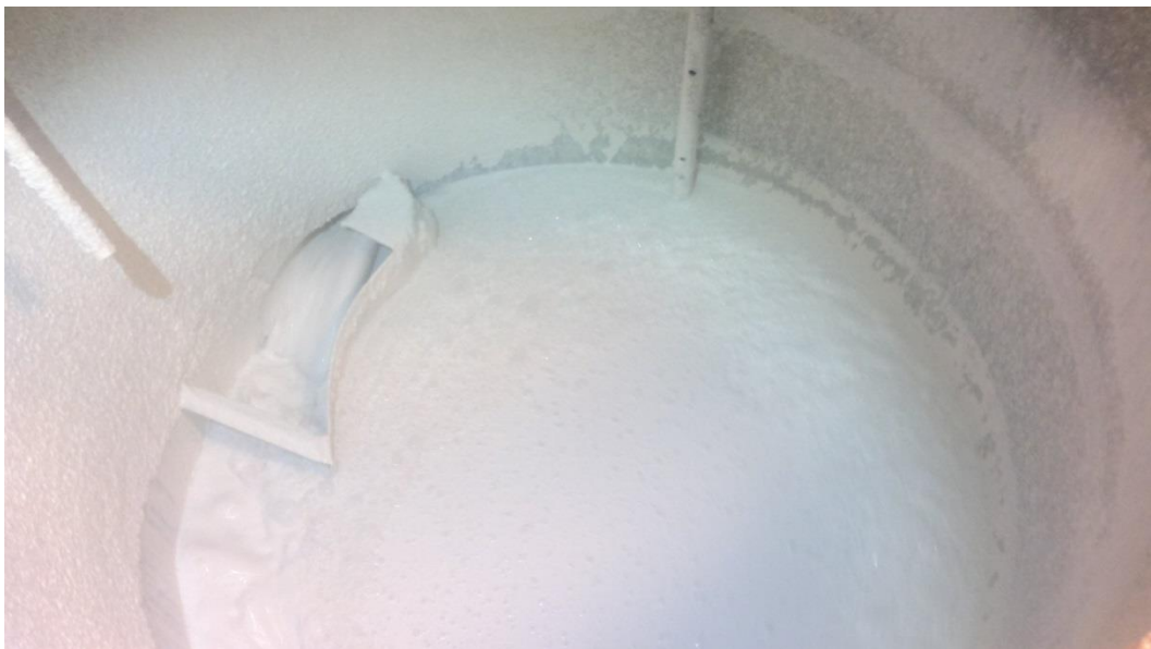
KUVA 9. Pastasäiliön pinta-asetus 50% vähiten vaahtoa (Metsä Board Tako, Simo Wilen)
