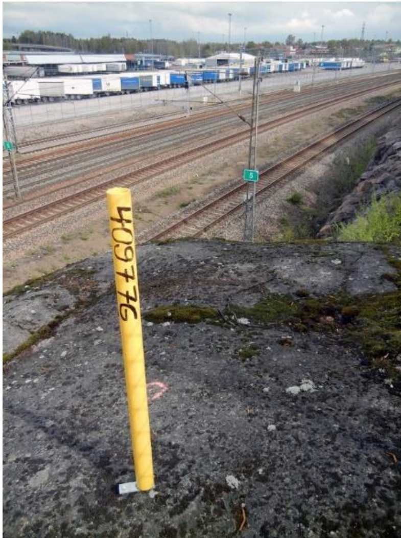
Kuva 24. Liikenneviraston kiintopisteen 409776 keltainen näkyvöittämisputki. Varsinainen kiintopiste on pultattu kallioon sen alle. Taustalla näkyvässä sähköratapylväässä on sekä paikantamis- että kuvassa näkymätön kilometrimerkki 5.
