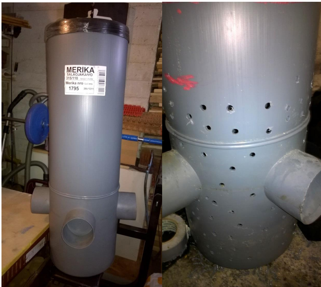
Kuva 12. Kaivo ennen ja jälkeen reiityksen. (Kuvat: Ville Taskinen)
