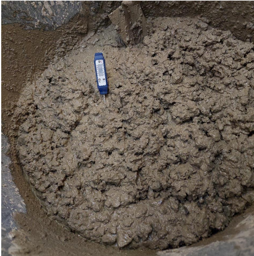
Kuva 9. Uusiobetoni 20 % 0/8 mm kiviainesta korvattu
