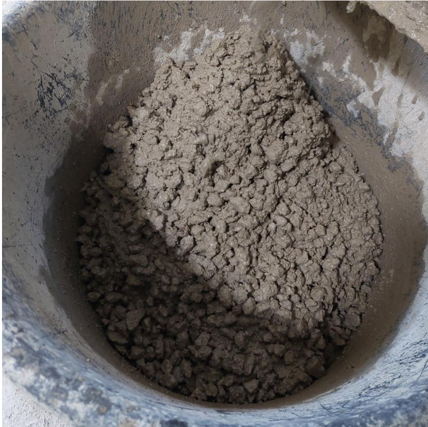
Kuva 12. Uusiobetoni 50 % 6/16 mm kiviainesta korvattu
