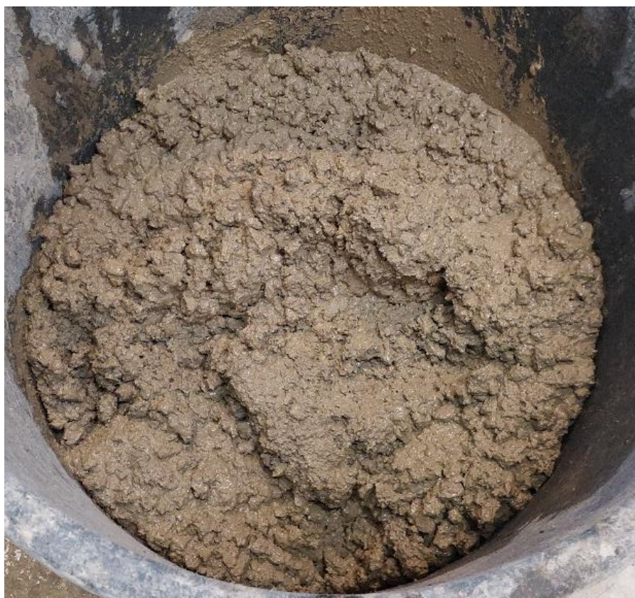
Kuva 10. Uusiobetoni 50 % 0/8 mm kiviainesta korvattu
