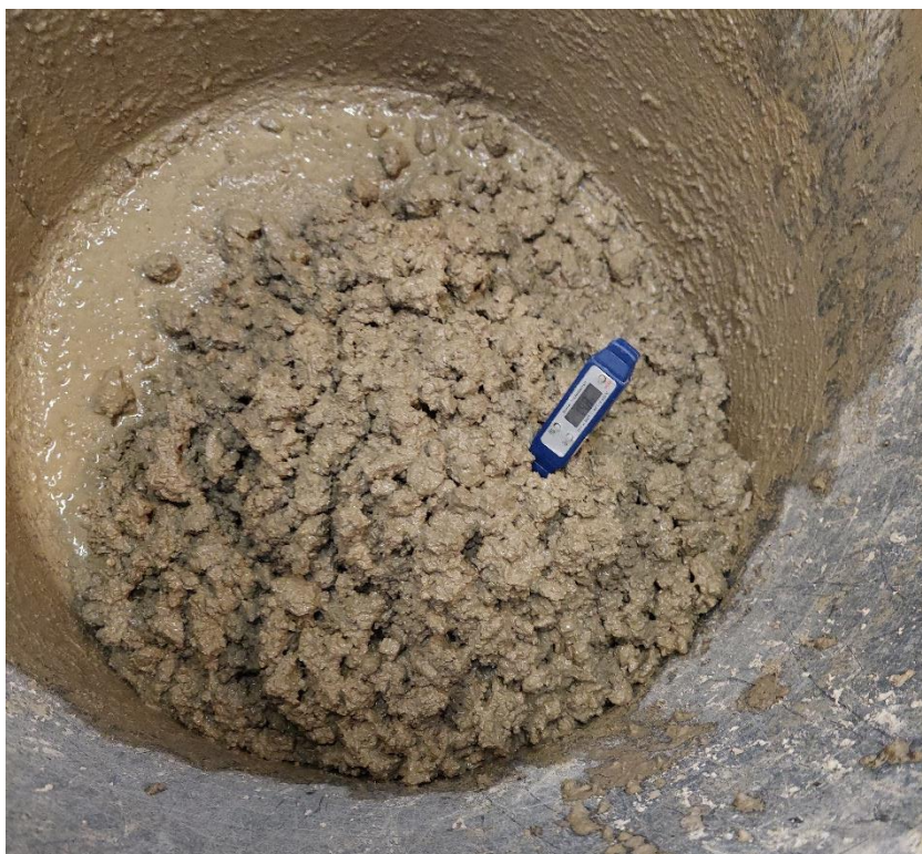
Kuva 11. Uusiobetoni 60 % 0/8 mm kiviainesta korvattu
