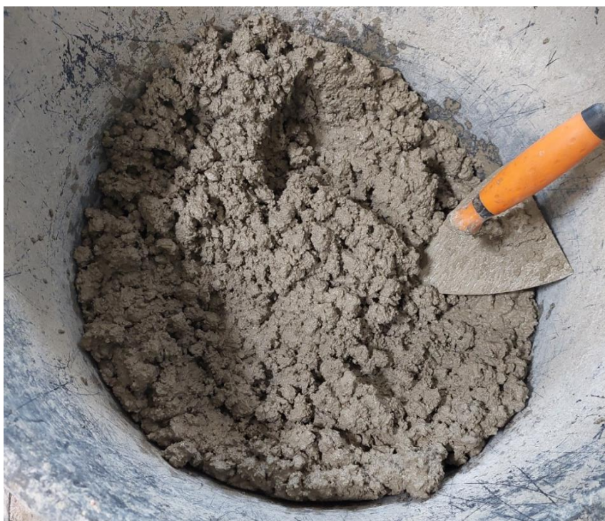
Kuva 13. Uusiobetoni 20 % 0/8 mm ja 50 % 6/16 mm kiviainesta korvattu
