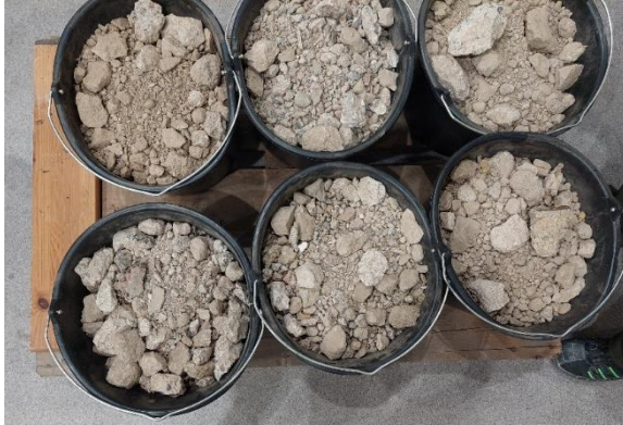
Kuva 2. Purkutyömaalla murskattu purkubetoni
