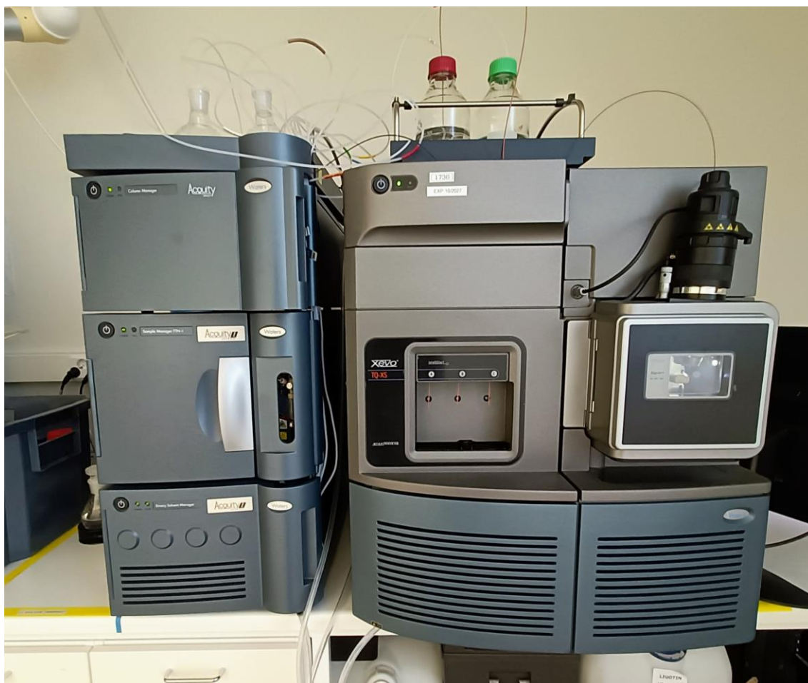
KUVA 2. Waters Corporation ACQUITY UPLC I-Class PLUS Xevo TQ-XS UPLC-MS/MS -laiteyhdistelmä.
