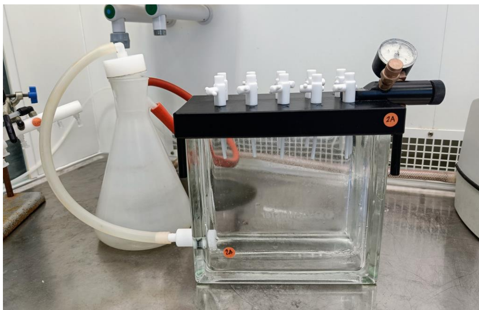
KUVA 3. Vakuumlaitteisto yhdistettynä Woulffin pulloon ja vesi-imuun
