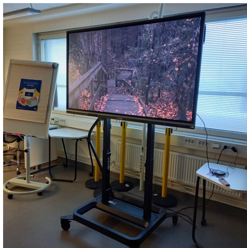
HILDA-boksi liitetään HDMI-kaapelilla television ja virtajohto sähköpistokkeeseen. Verkkoon yhdistämisen jälkeen boksi on käyttövalmis. Toimintojen valinta tehdään kaukosäätimellä.
