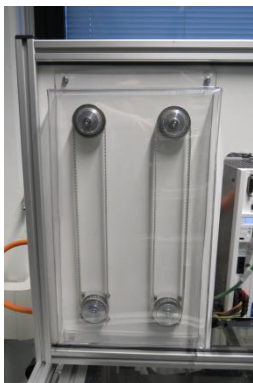
Kuva 12: Servomoottoreita kosketukselta suojaava polykarbonaattikuori.
