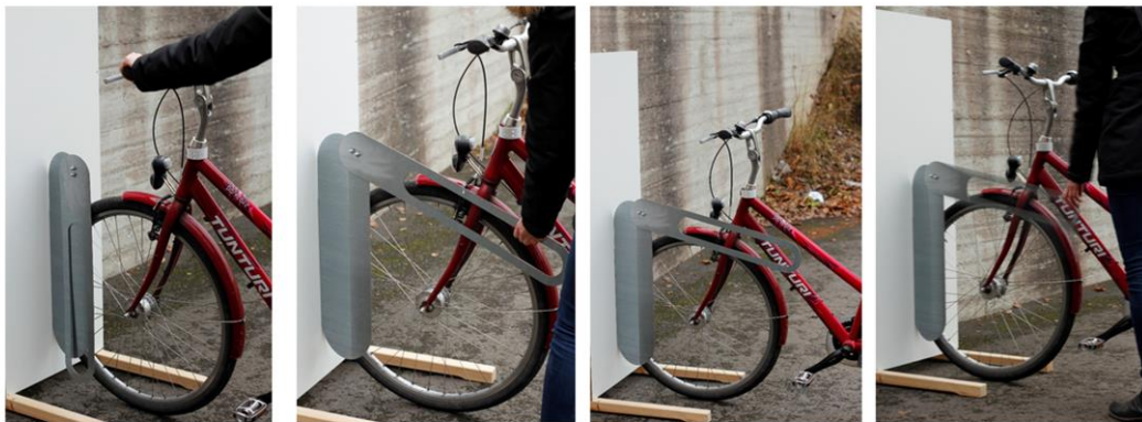
Kuva 23. Pyörätelineen toinen metalliprototyyppi (Hönö, 2014)
