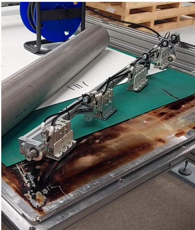
Kuva 19. Tarraimen sylinterit kiinni alumiiniprofilissa.
