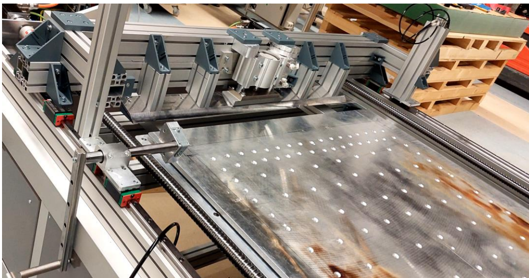
Kuva 16. Terä kiinnitettynä kelkkaan ja tyhjiöpöytä.
