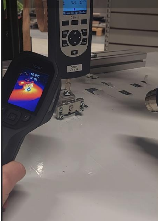
Kuva 12. Testi lämmityksellä ja vakiovoimalla
