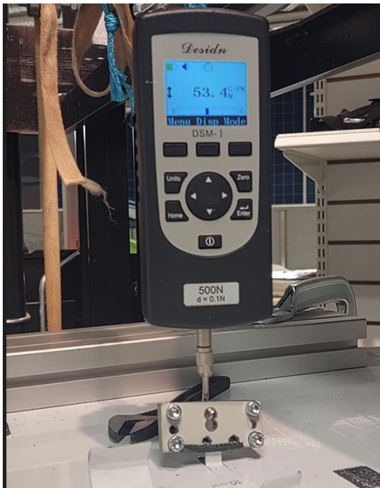
Kuva 10. Ilman lämmitystä, 10 mm leveydelle suoritettava vetokoe.
