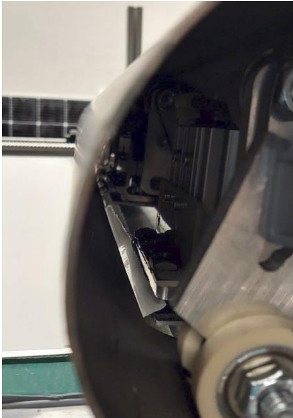
Kuva 24. Takakalvon ohjaus tarraimen leukojen väliin.
