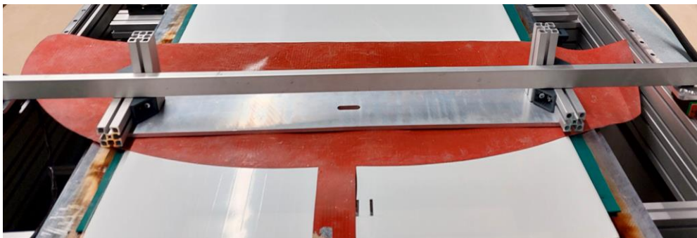
Kuva 21. Silikoninen vastusmatto takakalvon lämmitykseen ja sen kuljetin.
