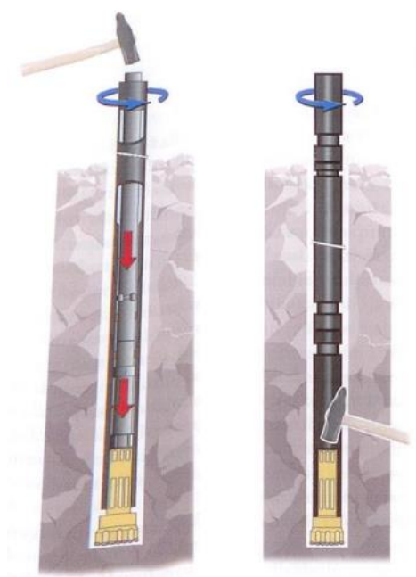
KUVA 3. TH ja DTH porausmenetelmät. (Hakapää & Lappalainen 2011, 140).
