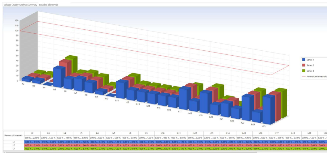
Kuva 33 PKB3-jännitteen harmoniset yliaallot normalisoituna
