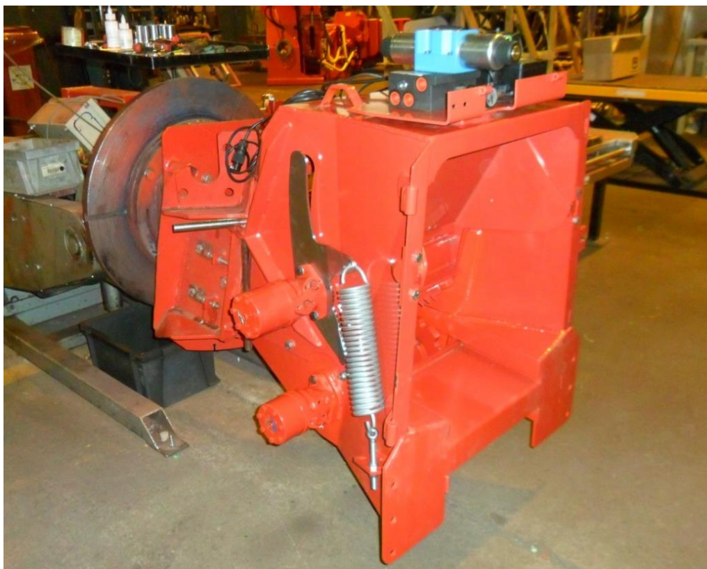
KUVA 9. Hakkurin syöttölaite esivarustelu
