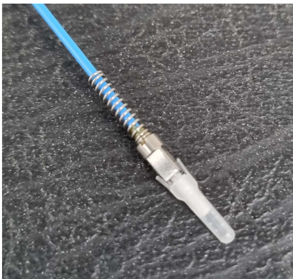
KUVA 14. NBFU-kaapelin koottava LC/APC-liitin ennen puhallusta (Juliander 2024).
