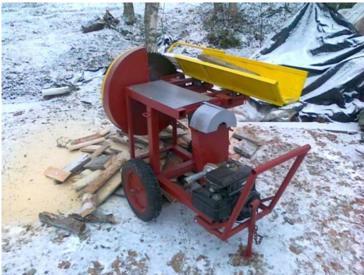
KUVA 13 Prototyyppi sirkkeli oli testikäytössä marraskuussa (Korhonen 2014)
