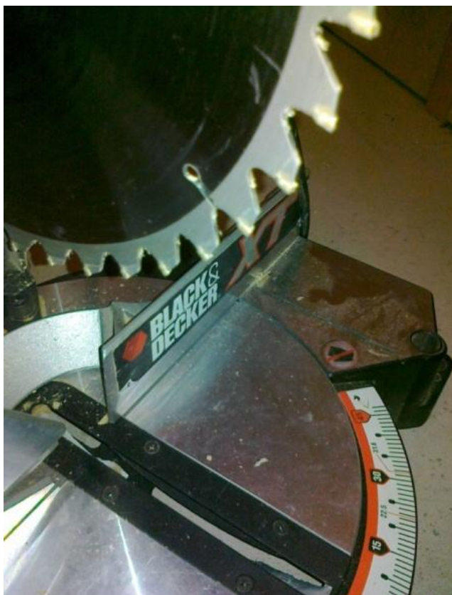
KUVA 3. Black & Decker-jiirisirkkelin laadukas kovapalaterä. (Korhonen 2014)
