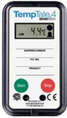
Figur 1. Temptale 4-mätaren, som registrerar temperaturen under en transport som varar över fyra timmar.
