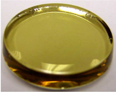
KUVA 6, Alle 100 \mu\text{m} :n raekoko, hyvä näyte (15, s. 63).
