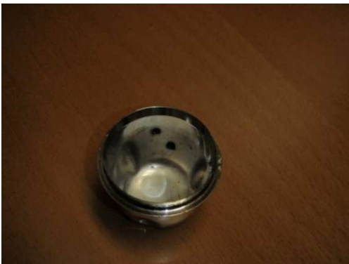
KUVA 8. Rikkoutunut upokas, joka on reagoinut näytteen kanssa. Kuva on otettu vuonna 2012 Raahessa.
