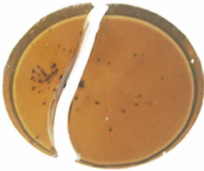
KUVA 7. Yli 100 \mu\text{m} :n raekoko, huono näyte (15, s. 63).
