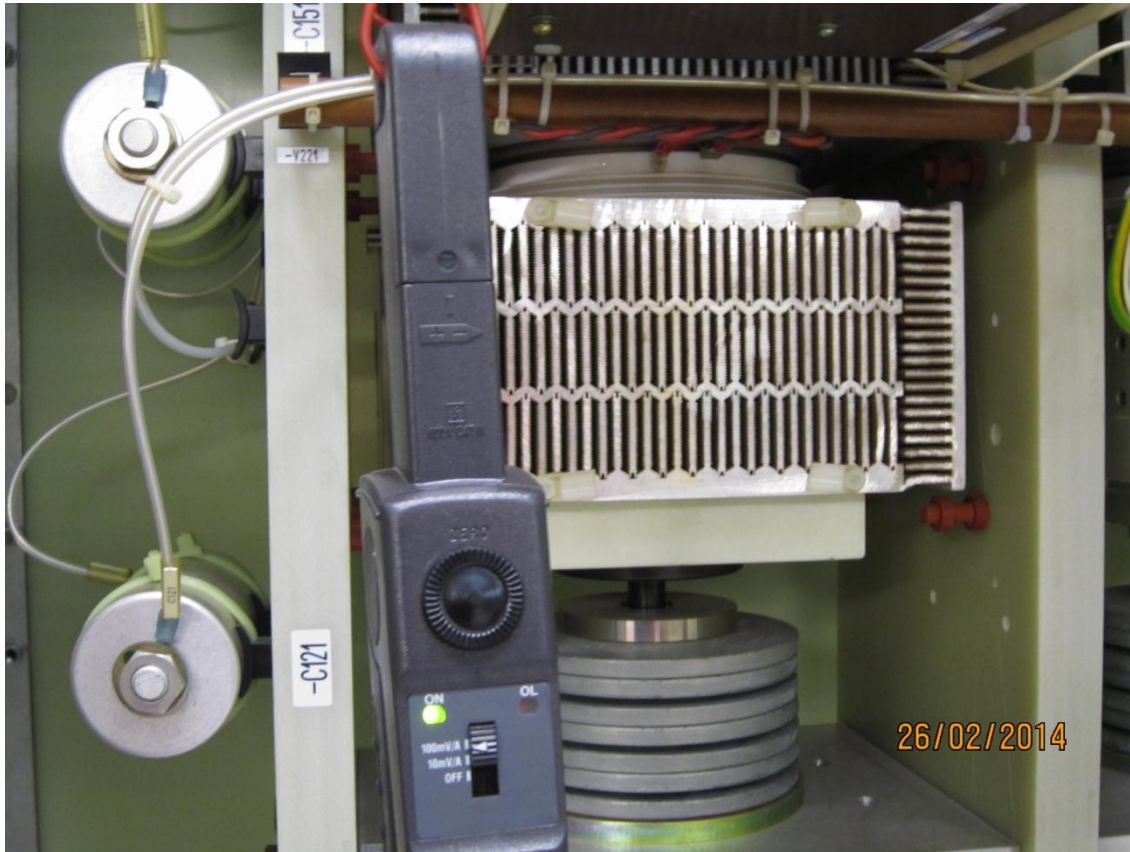
Kuva 3. Kuvassa nähdään mihin mittapää laitetaan mittaustilanteessa. (Spets 2014)
