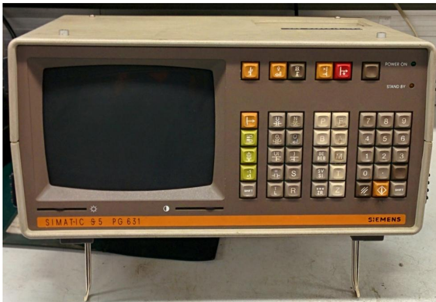
Kuva 25. Siemens S5 -ohjelmointilaitte (Tero Heinonen 2014).
