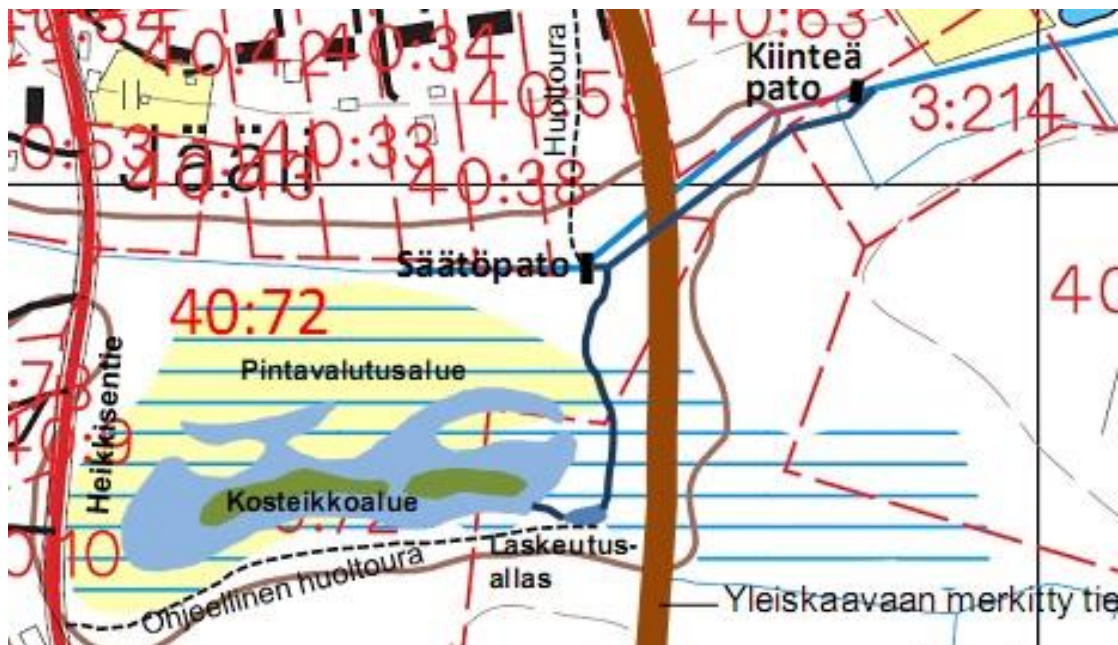
KUVA 10. Suunnitelma Korteojan vesienhoitorakenteiden sijainnista (Kiimingin-Jäälin vesienhoitoyhdistys)
