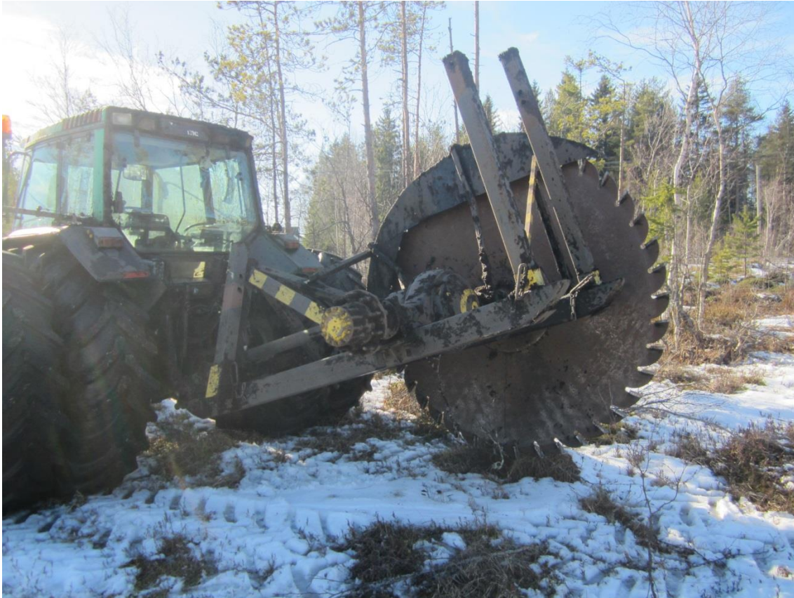
KUVA 17. Kardaaniulostuloa voimanlähteenään käyttävä jääleikkuri
