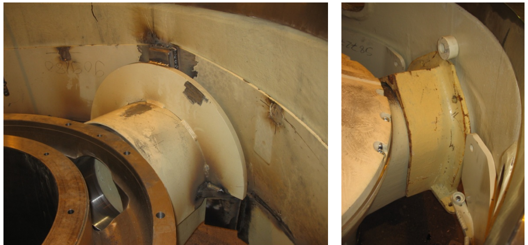
Kuva 12. Levystä tehty ja valettu ala-arminsuoja alarungossa /3/
