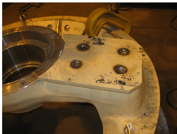
Kuva 10. Valettu ja levystä tehty murskaimen yläarmiensuoja /3/
