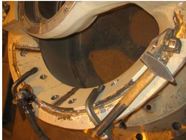
Kuva 29. GP300:n ylärungonsuojat paikoillaan valmiina hitsattavaksi /3/
