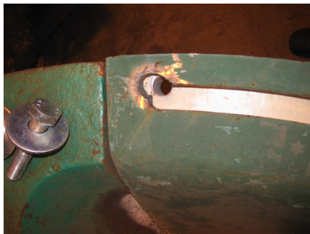
Kuva 28. Ylärungonsuojien sovitus ylärunгон kiinnitysreikiin /3/
