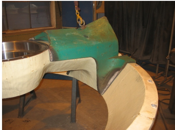
Kuva 27. Ylärunгон arminsuojan sovittaminen ylärunkoon GP500S:ssä/3/
