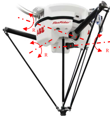
Kuva 23. ABB:n rinnakkaisrakenteinen IRB 360 FlexPicker robotti (ABB 2015).
