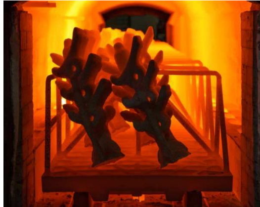
Kuva 6. Kuorien sintraus ja esilämmitys tunneliuunissa (Sacotec 2014).
