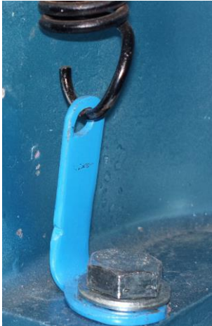
Kuva 25. kevennysjousen kiinnike asennettuna.
