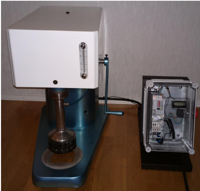
Kuva 29. Vaahdotuskenno valmiina luovutettavaksi.
