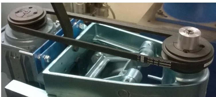
Kuva 11. Kiilahihnapyörät asennettuna akseleille.
