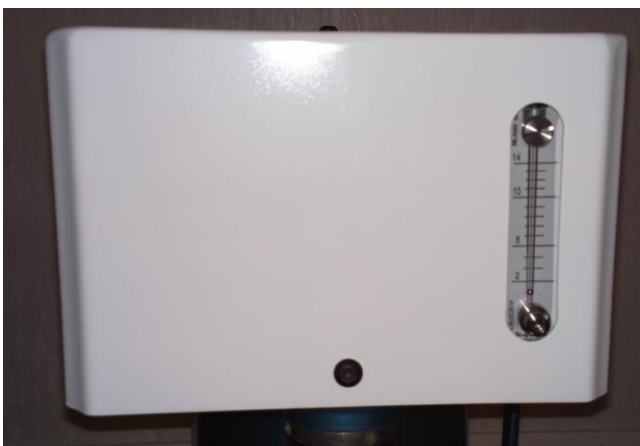
Kuva 18. Rotametri asennettuna valmiin kotelon sisälle.
