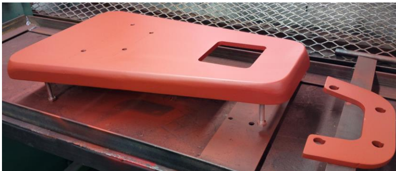
Kuva 27. Rungon pohjalevy ja korokerengas ruskeaksi pohjamaalattuna.
