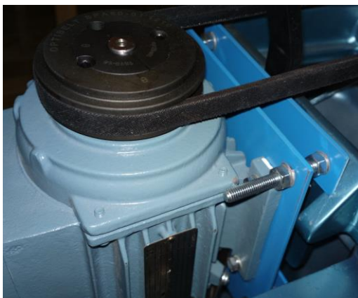
Kuva 16. Moottori kiinnitettynä moottoripukkiin.
