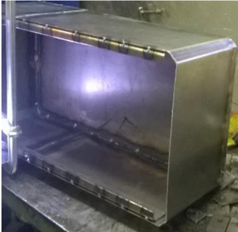
Kuva 17. Kotelon sisätukien hitsausta.
