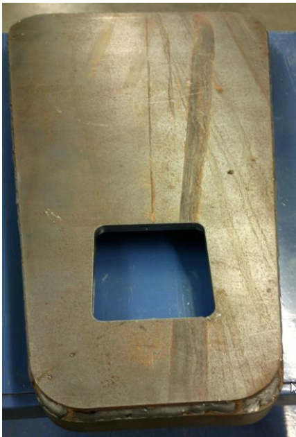
Kuva 15. Pohjalevyyn hitsattiin lattarauta kiinni.
