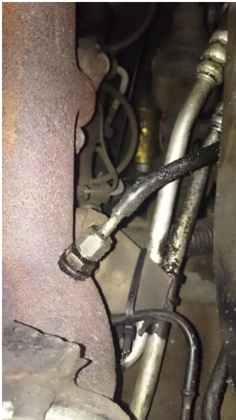
Kuva 15 pyrometrin anturi pakosarjassa (Aaltonen 2015)
