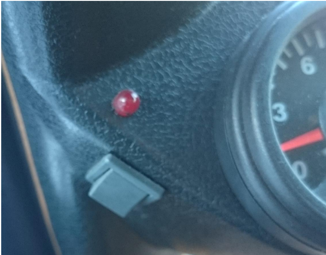
Kuva 6 Tilaajan autossa keinukytkimellä kytketään lisämittarien taustavalot (Aaltonen 2015)
