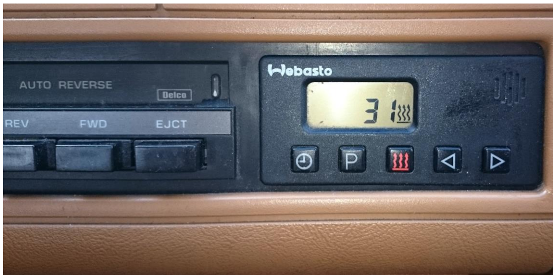
Kuva 9 Webaston kellokytkin asennettuna alkuperäisen kasettisoittimen viereen. (Aaltonen 2015)
