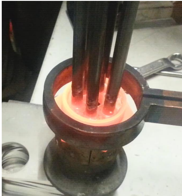
Kuva 11 Kierrelaipan juotos laboratoriossa
