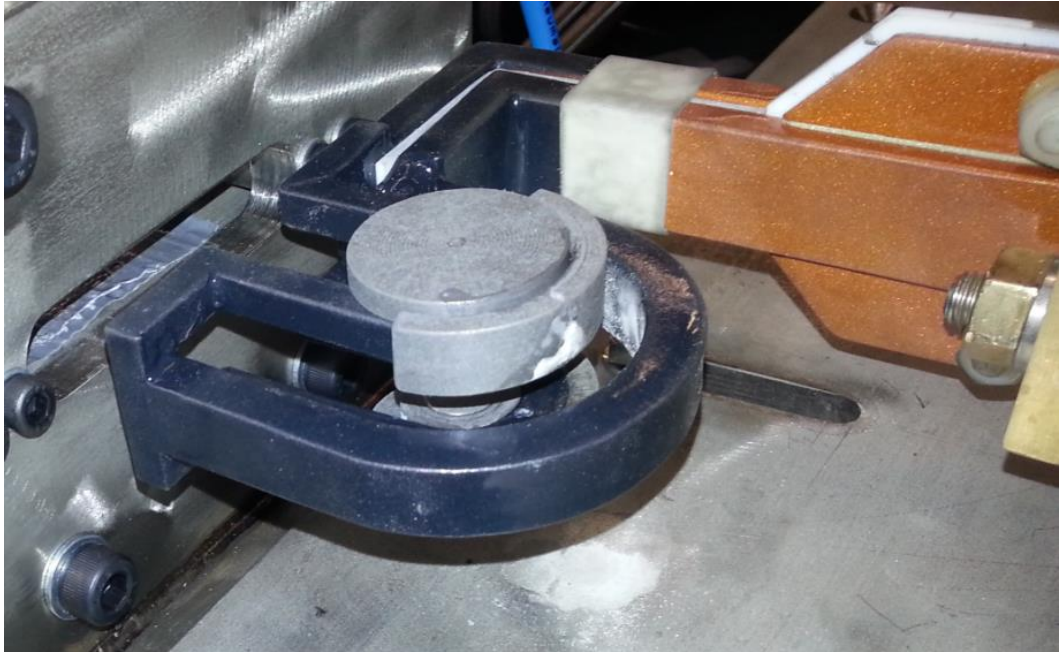
KUVA 17. Induktiokelan toinen versio. Ferriittipalat ohjaavat magneettikentän tehokkaammin kuumennettavaan kohteeseen.
