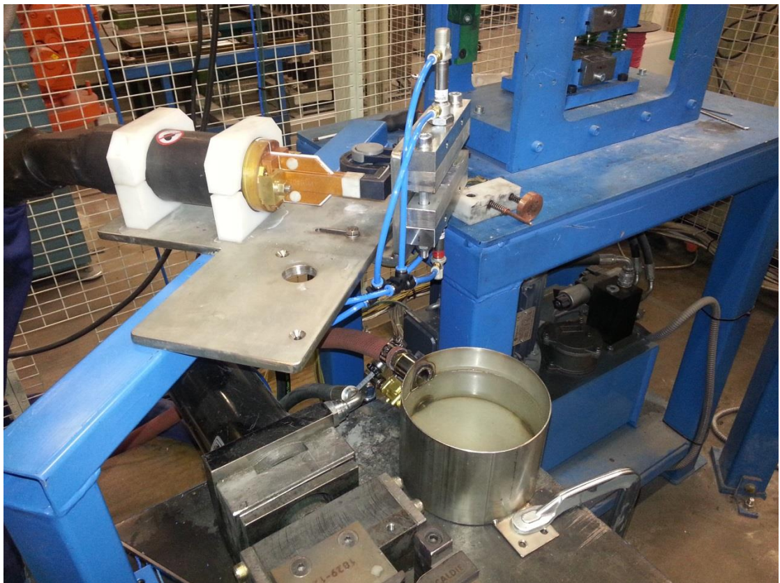
KUVA 22 Induktiokelan, kiinnipitopuristimen ja jäähdytysastian sijoitus robottisoluun
