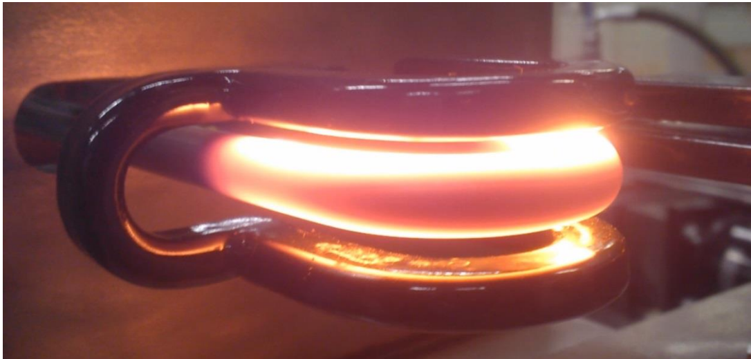
KUVA 23. U-mutkan vääränlainen kuumeneminen
