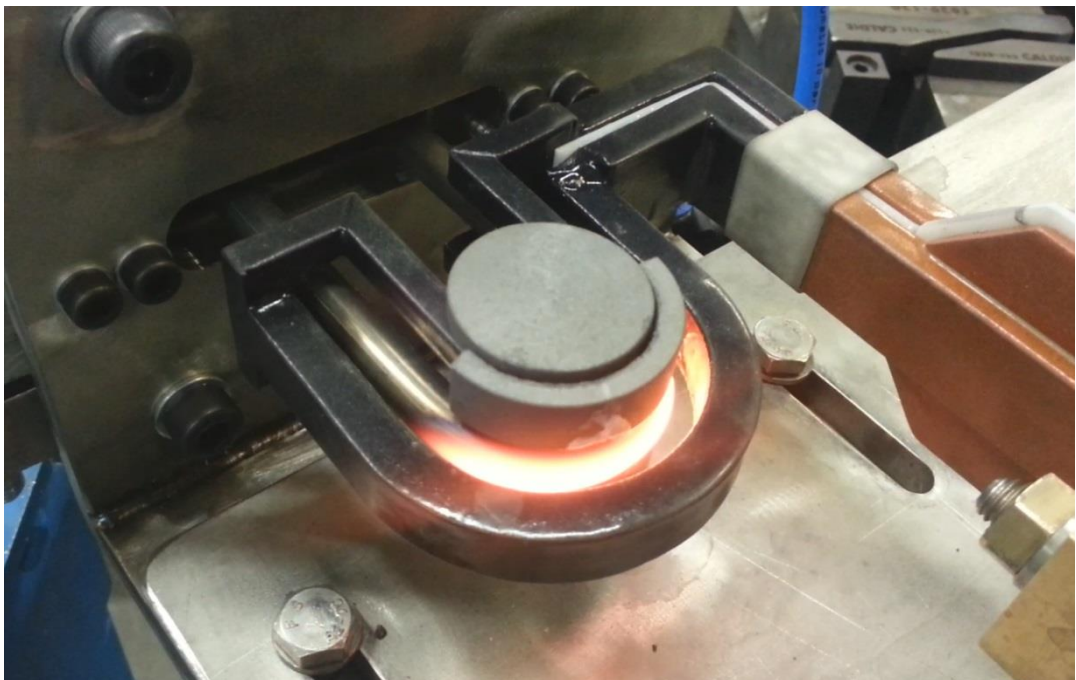
KUVA 25. Uuden induktiokelan oikeanlainen kuumennus
