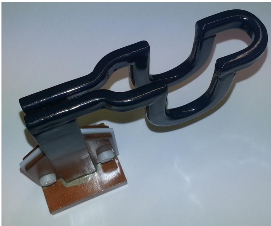
KUVA 15. Induktiokela U-mutkan hehkutukseen
