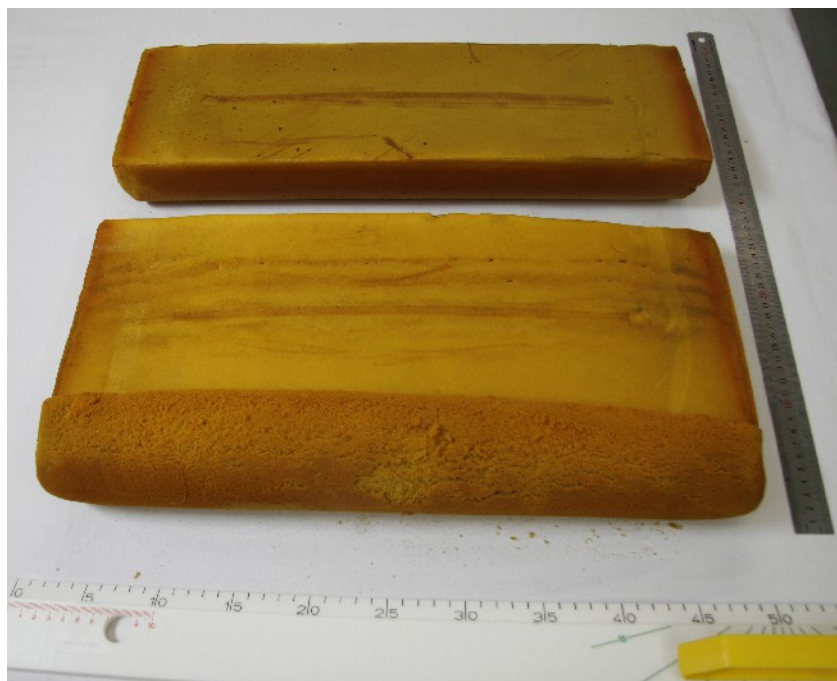
Kuva 1. Alempi pehmuste on selkänojan pehmuste, ylempi ristiselän pehmuste, joka on huomattavasti paremmassa kunnossa eikä siitä irtoa tai ole irtoamassa palasia.
