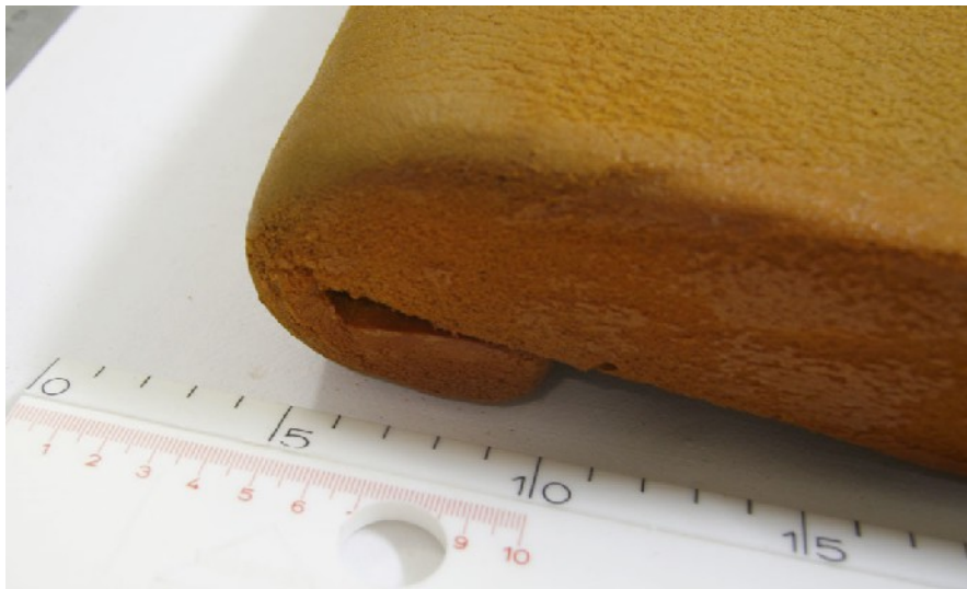
Kuva 12. Selkänöjapehmusteen haurastunut taitekohta. Kuva Katri Kurkela
