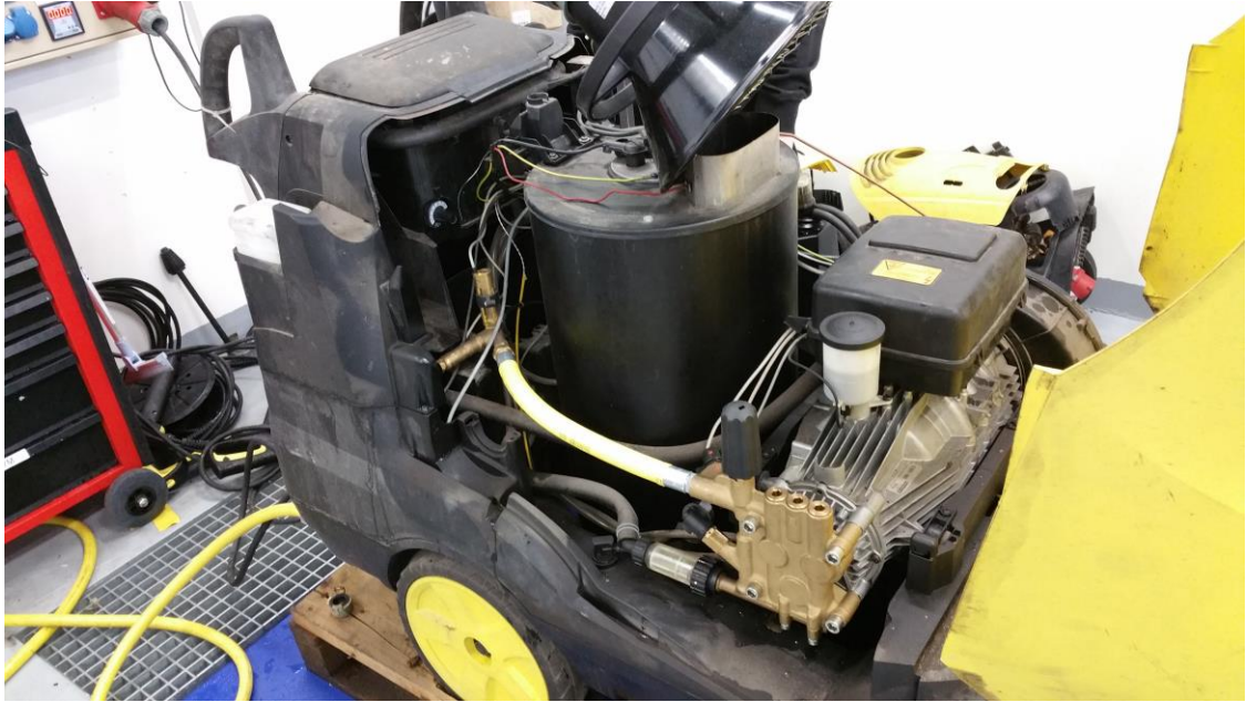
Kuva 3. Kuumavesipainepesuri. Vasemmalla kattila ja oikealla triplex-pumppu.
