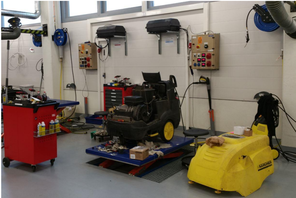
Kuva 4. Huoltopiste, jossa huollettavana kuumavesipesuri.
