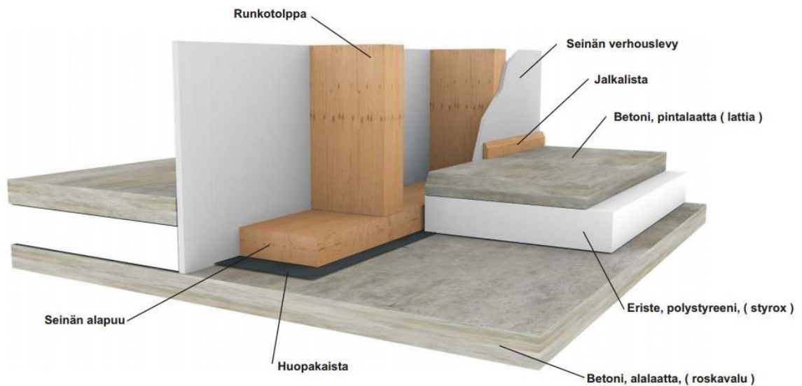
Kuva 4. Puurakenteinen väliseinä eristämättömän alalaatan päällä (Ympäristöministeriö, 2015, 10)
