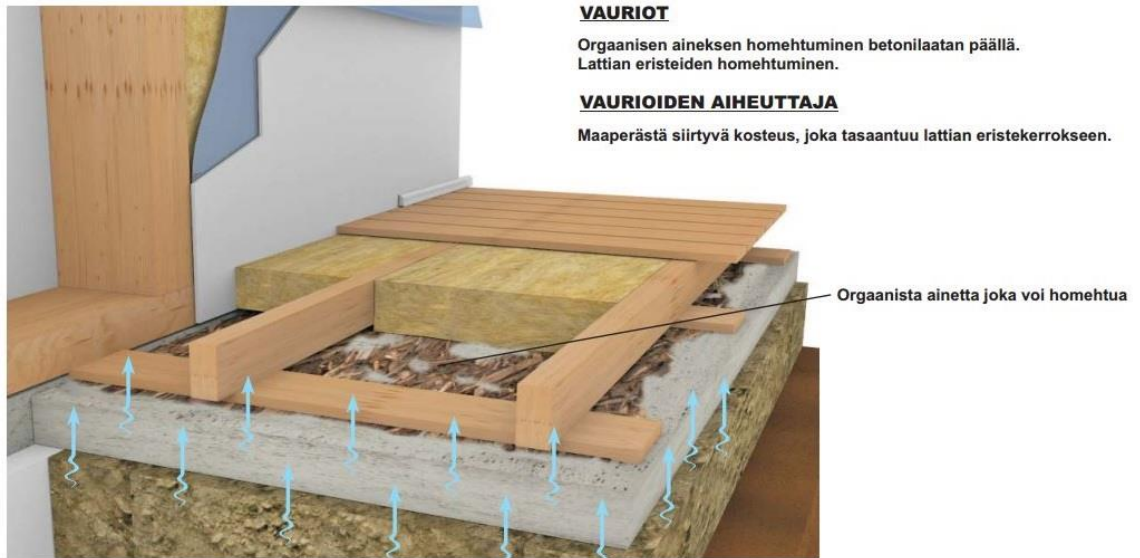
Kuva 3. Puulattia eristämättömän betonilaatan päällä. Ongelmia aiheuttaa lisäksi sisäilman kosteuden tiivistyminen kylmän betonilaatan yläpintaan. (Ympäristöministeriö, 2015, 10)
