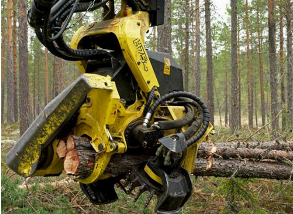
Kuva 1. Energiapuun joukkokäsittelyä syöttävällä harvesterikouralla (4)
