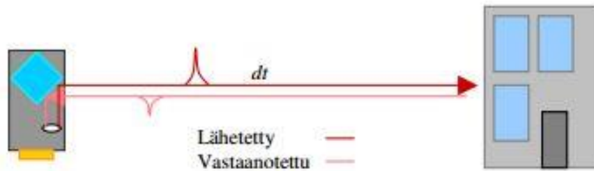
KUVA 2. Laserpulssin kulku aikaan perustuvan laserkeilaimen toimintaperiaate (Kukko, A. 2005, 7)
