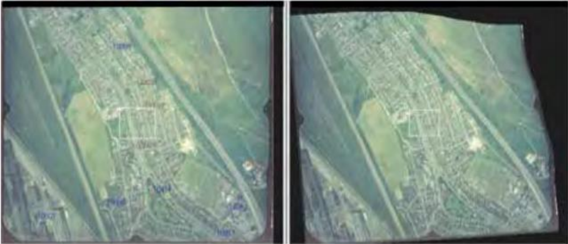
Figur 8. Bilden till vänster ett flygfoto och bilden till höger är ett ortofoto. Det är ett berg uppe i högre hörnet. Höjddplaceringen i bilden har blivit korrigerat i ortofotot.
