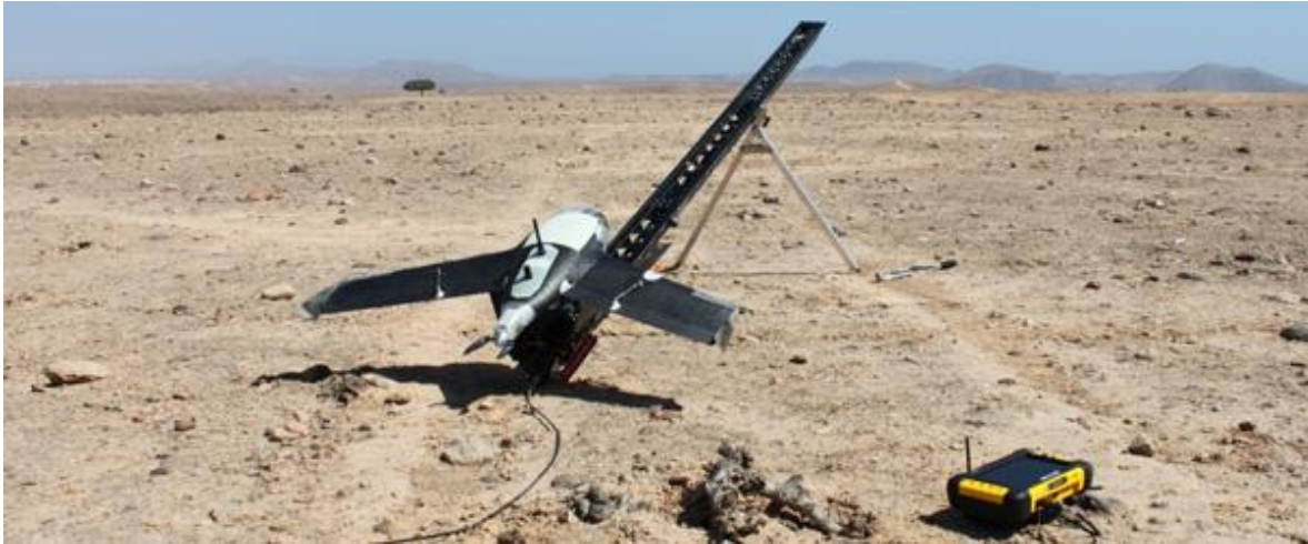
Figur 6. En Gatewing UAV på en startramp.
