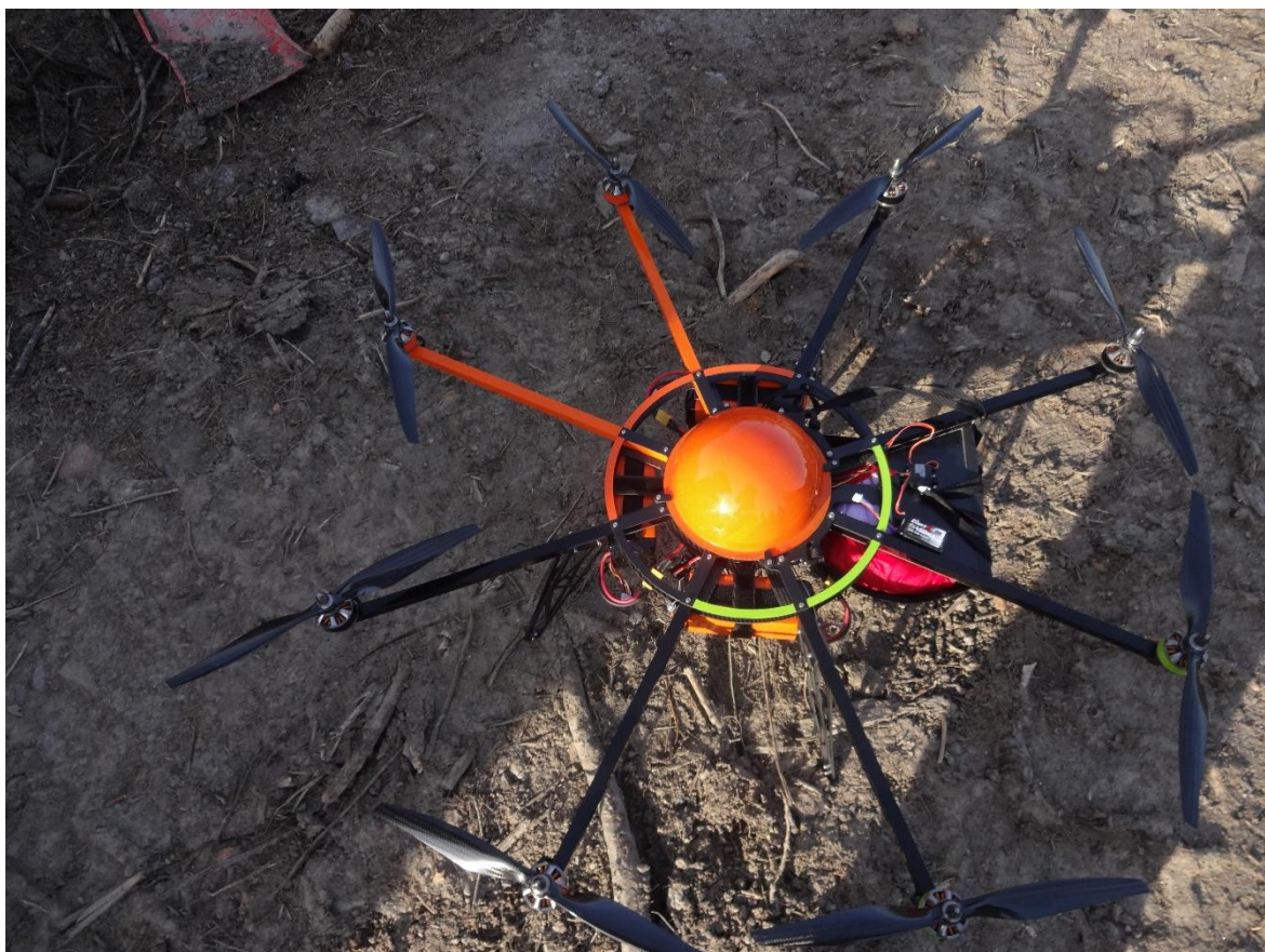
Figur 16 Ilkka Vallis multikopter Camflight 8. Det var denna ocktocopter som tog alla bilder för detta examensarbete.
