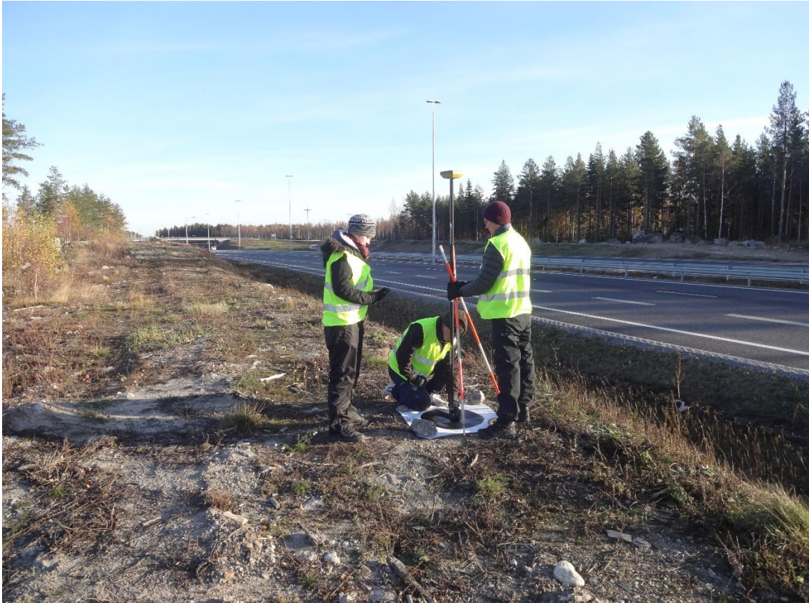
Figur 17. Här mättes en signal av några av studerandena som hjälpte till under flygningen. En person höll GNSS-staven på spiken och den andra höll staven stadigt med hjälp av två stödkäppar.
