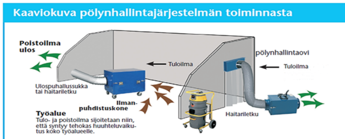
KUVA 7. Alipaineistuksen toteutus (Koski – Mattila – Taipale 2013)
