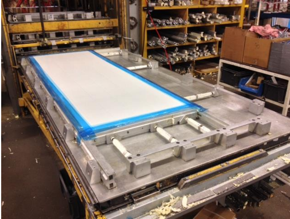
KUVA 6. Elementti muotissa valmiina laitettavaksi puristimeen (Työohje TY1-0700 2014)
