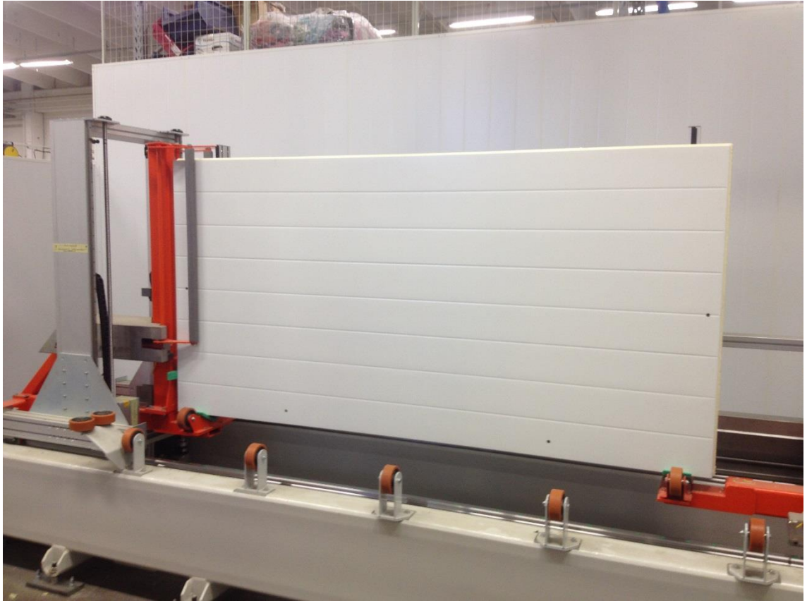
KUVA 7. Valmis seinäelementti tarkastuksessa lasermittauslaitteella (Santeri Suni 2015)
