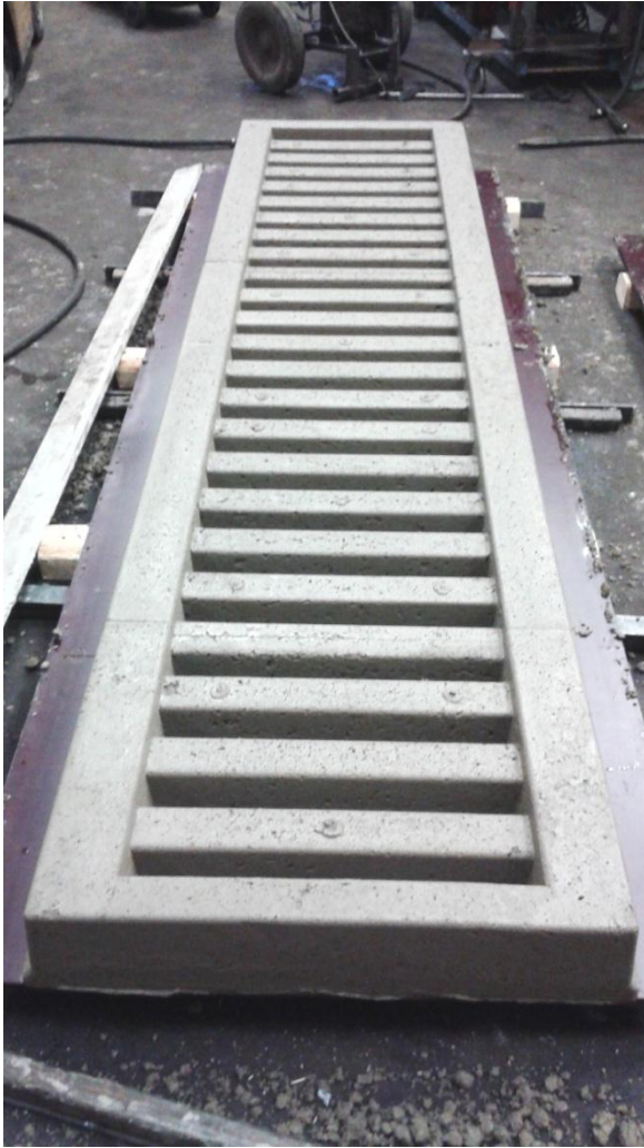
KUVA 16. Valmiit rakolattiaelementit jätetään kovettumaan pohja ylöspäin
