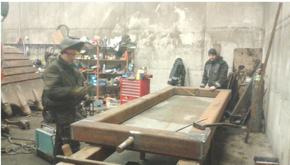
KUVA 13. Muotin kehikko, jonka sisään asennetaan koneistetut muoviosat
