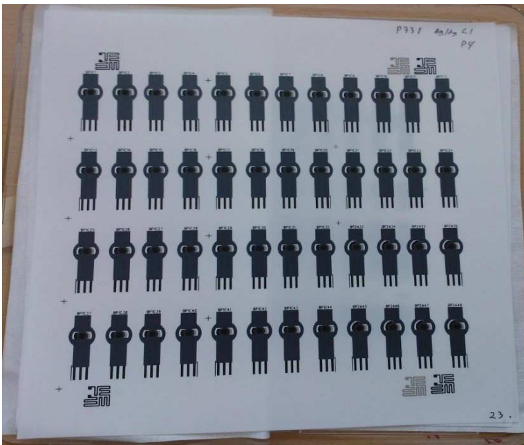
KUVA 5. Kuvassa on silkkipainotekniikalla painettuja grafiittisensoreita muovikalvilla.
