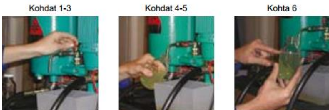
KUVA 14. Pullonäytteenoton vaiheet (17, s. 5)
