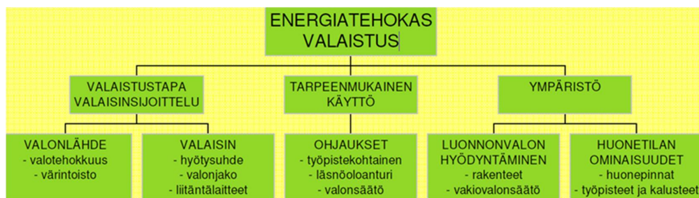
KUVA 16. Valaistuksen energiatehokkuuteen vaikuttavia tekijöitä (Suomen Valoteknillinen Seura 2008, 24).
