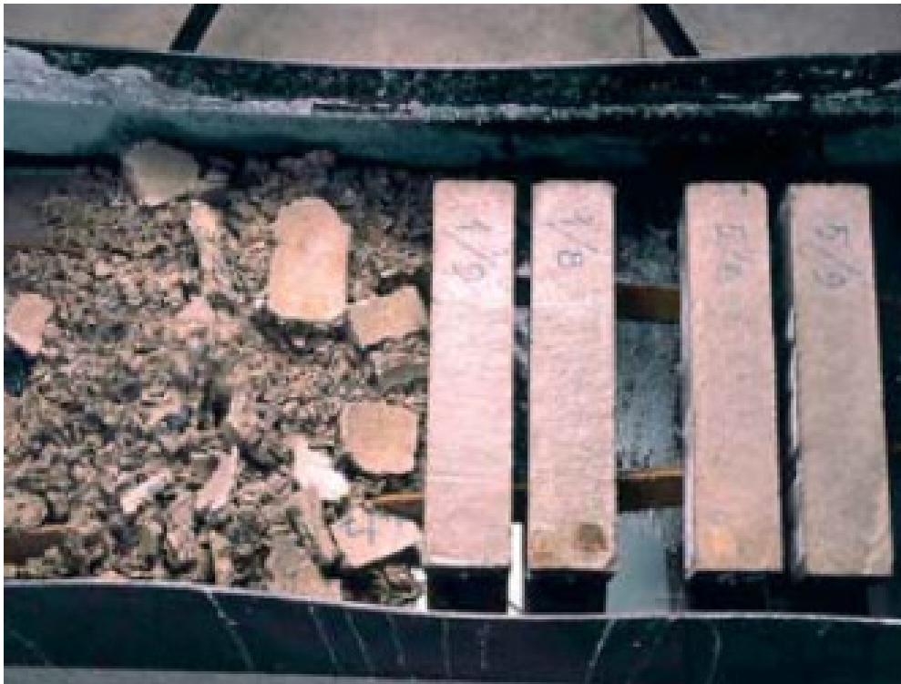
Kuva 7. Sulfaatinkestävyyssuoritus. Vasemmalla on murenneita betonipalkkeja, jotka ovat täysin hajoaneet, kun taas sulfaatinkestävät palkit säilyivät vahingoittumattomina. [11.]
