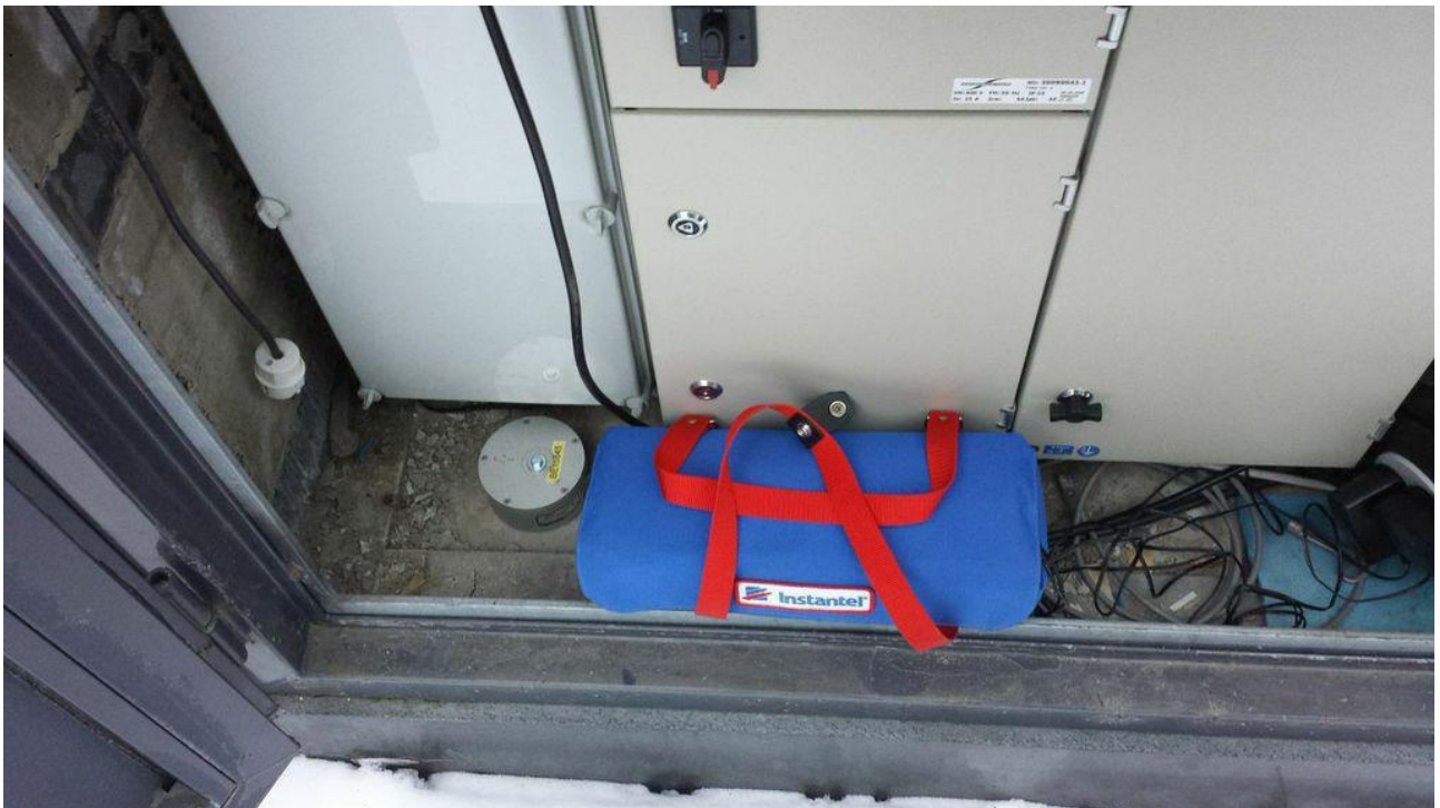
Kuva 5. Mittarin kiinnitys vaakapintaan
