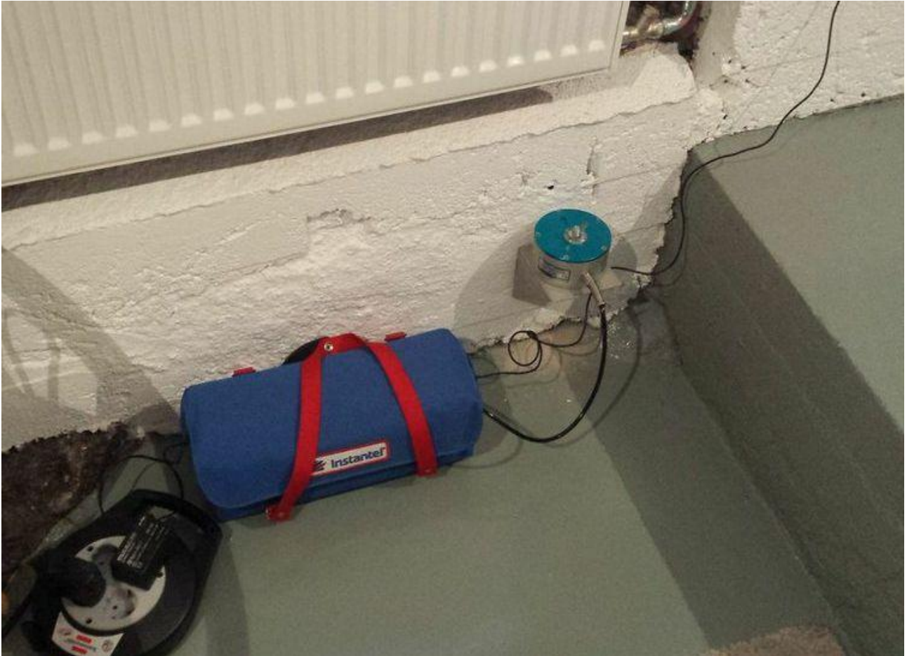
Kuva 6. Mittarin asennus pystysuoraan pintaan
