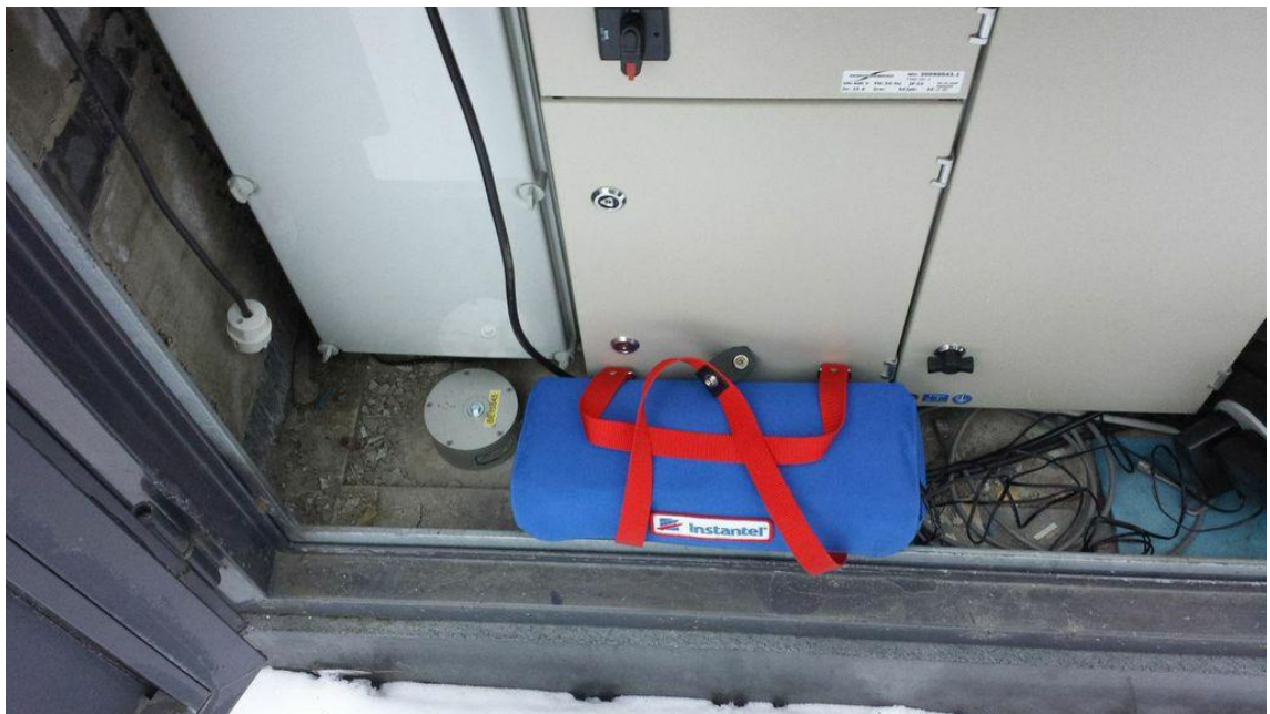
Kuva 18. Tärinäanturin kiinnitys vaakapintaan
