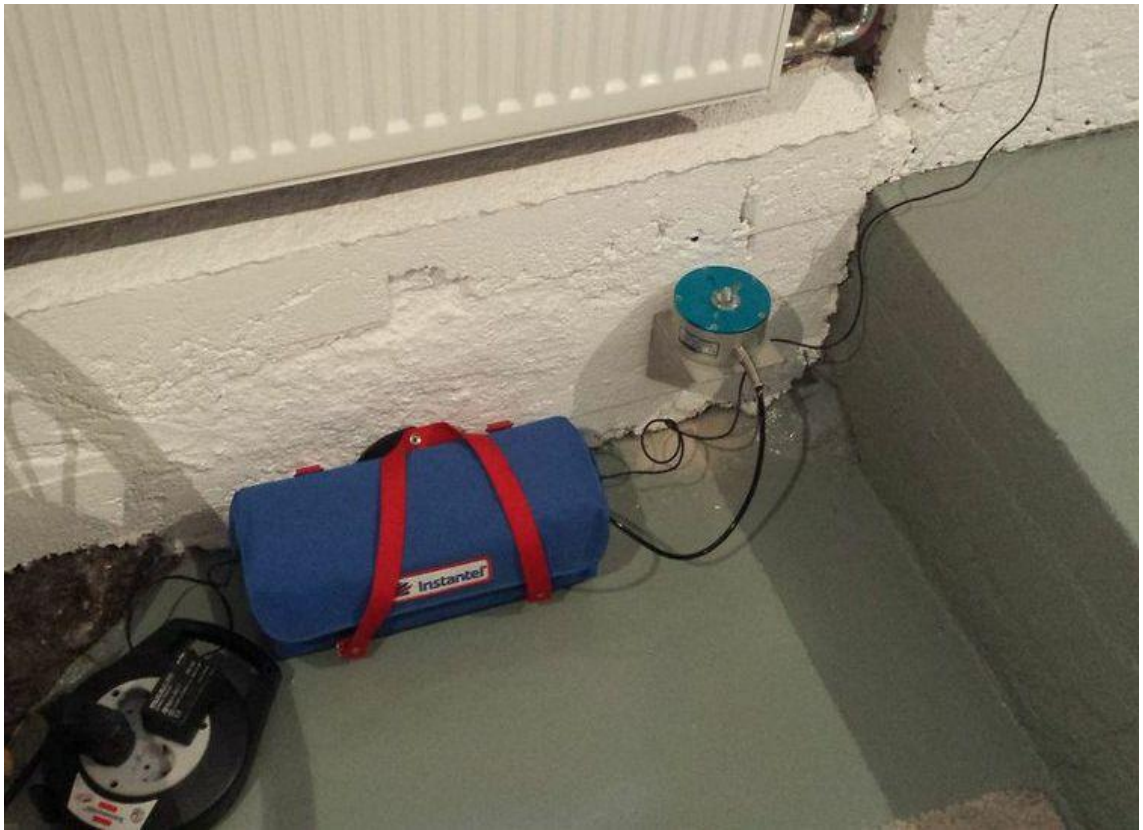
Kuva 19. Tärinäanturin kiinnitys pystysuoraan pintaan jalustalla
