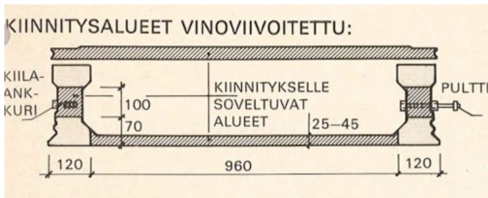
Kuva 8. Mahdolliset kiinnityskohdat Nilcon-kotelolaatassa. (SKB 1979)
